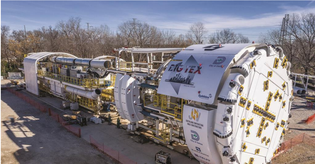
Slika 3-2. TBM za iskop odvodnog tunela (TBM, 2020.)
