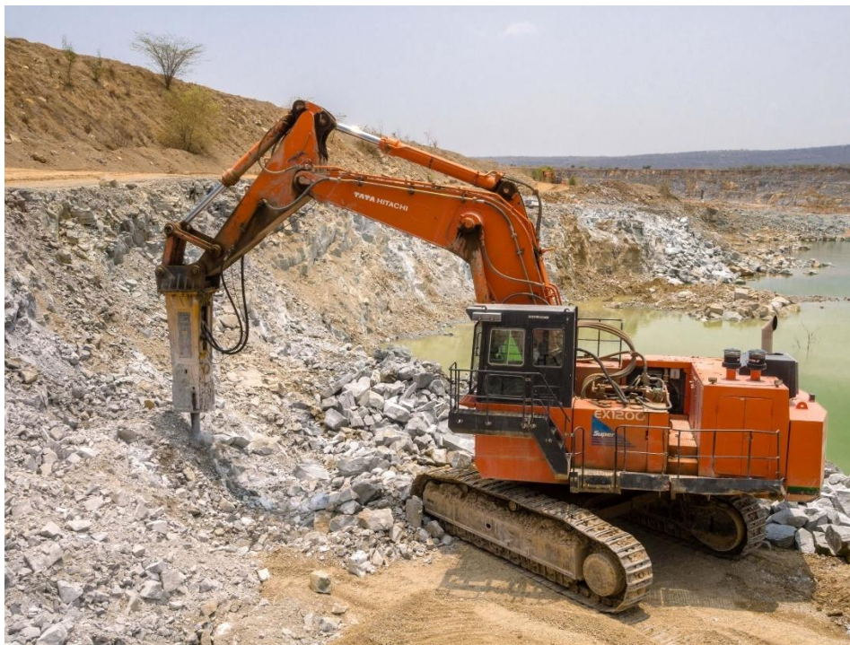
Slika 4-1. Hitachi 1200 s hidrauličnim čekićem u kamenolomu Chittorgarh (Hitachi 1200, 2016.)
