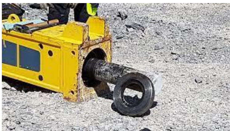
Slika 3-4. Zaštitni prsten (Epiroc zaštitni prsten, bez dat.)
