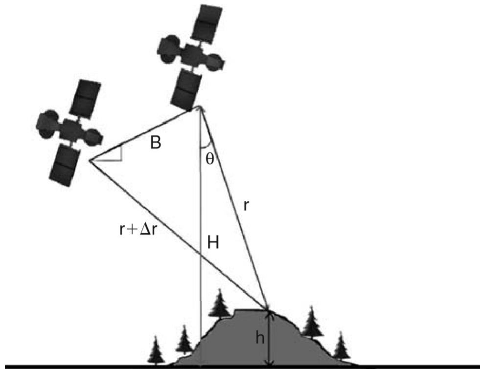
**Slika 2.6** InSAR princip mjerena (Düzung i Demirel, 2011.).
