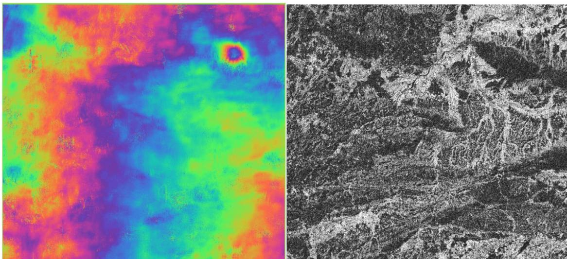
**Slika 5.4** SNAP proizvodi: Interferogram (lijevo) i koherentnost (desno).
