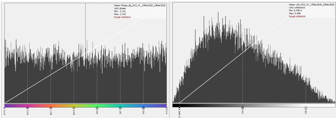
**Slika 5.3** Histogram interferograma (lijevo) i koherentnosti (desno).
