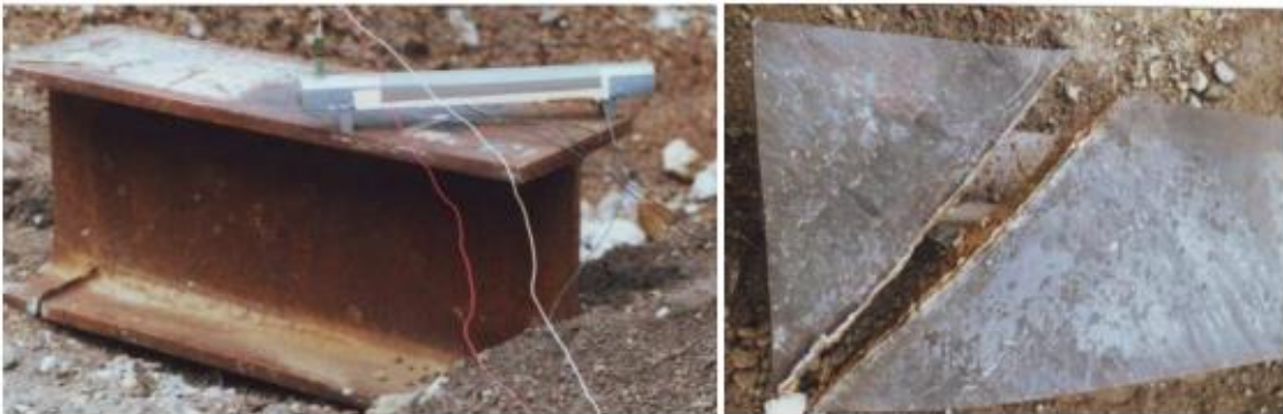
Slika 3-6. Linijski kumulativni naboj (Bohanek i sur., 2013)
