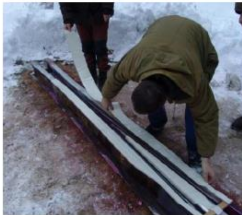
Slika 3-13. Postavljanje eksploziva na obradak (Havliček & Nesvadba 2011)
