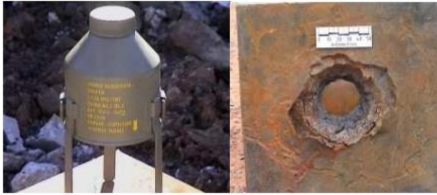
Slika 3-7. Konusni kumulativni naboj i perforacija nakon detonacije (Bohanek i sur., 2013)
