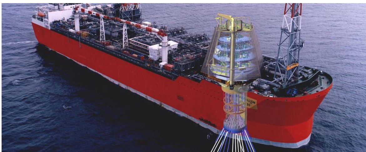
Slika 3-24. TMS na presjeku FLNG-a (JPT, 2014)
