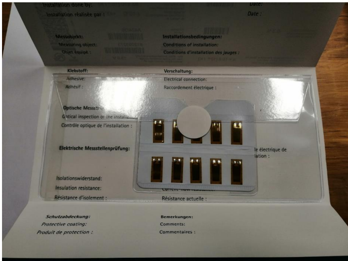
Slika 3-8. Elektrootporne mjerne trake.
