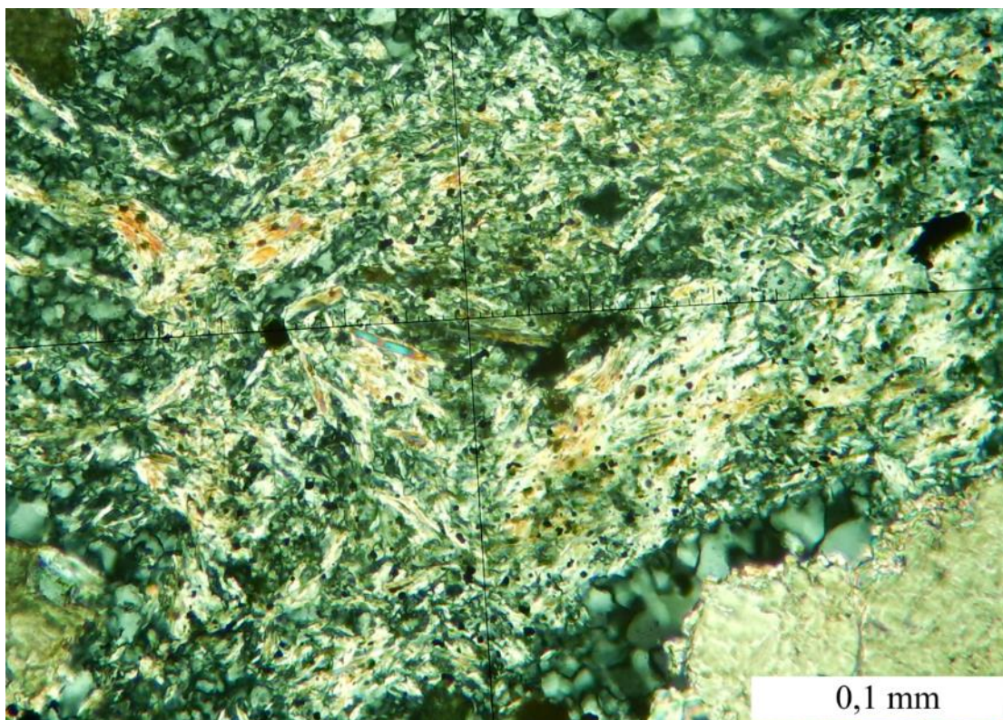
Slika 2-9. Sitno zrnati tinjac (sericit) udružen s mineralima sulfida (+N).
