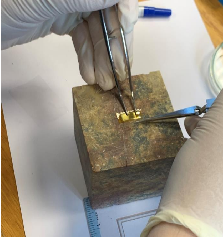
Slika 3-13. Postupak lijepljenja mjerne trake.
