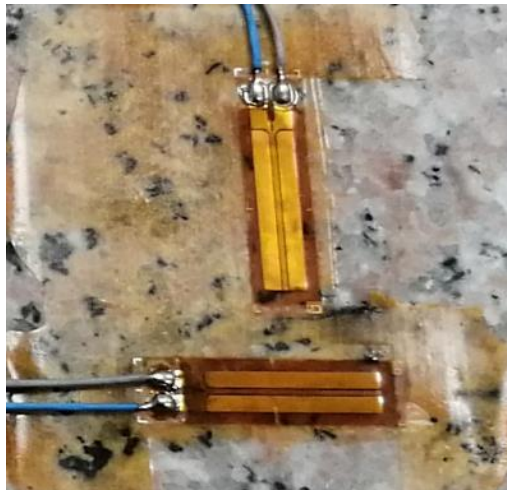
Slika 3-14. Zalijepljene mjerne trake.
