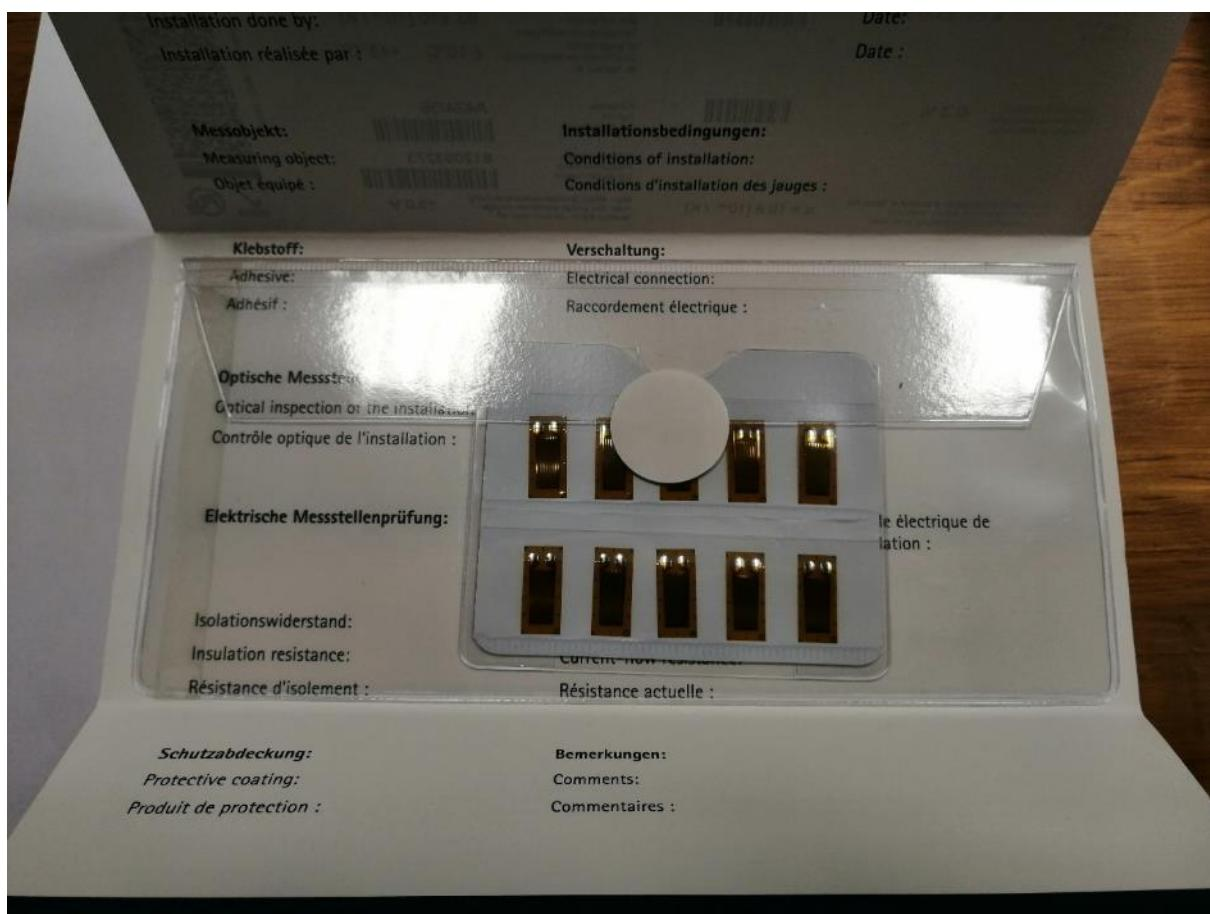
**Slika 3-8.** Elektrootporne mjerne trake.
