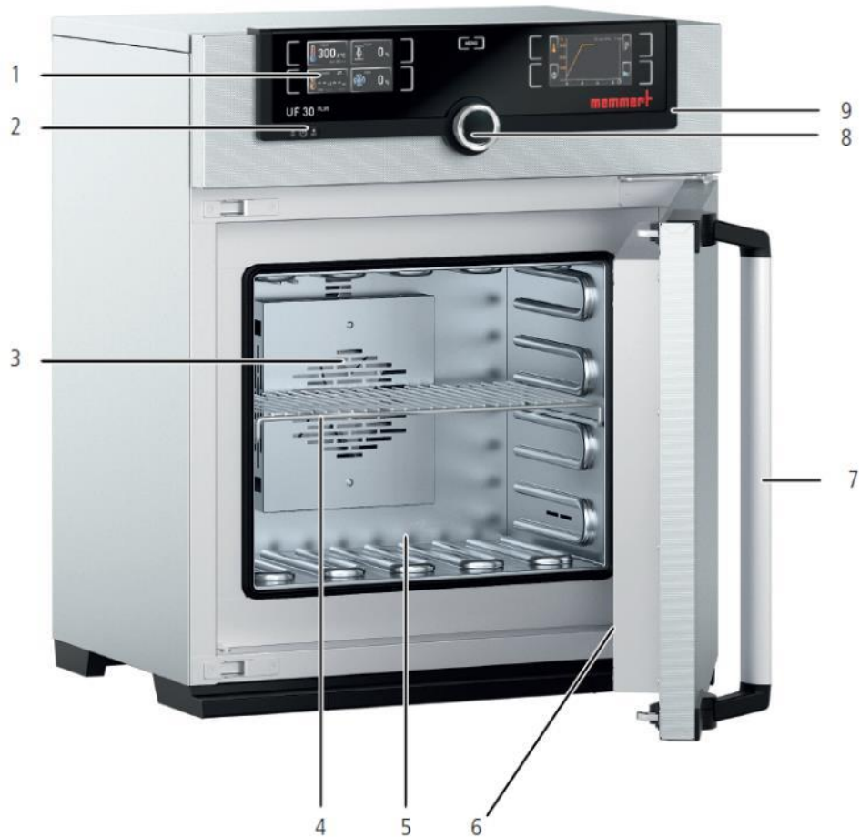
Slika 0-2. Klima komora s opcijom grijanja, hlađenja i kontrole vlažnosti, zapremine 1 \text{ m}^3 tvrtke Memmert (1 – kontrolna ploča, 2- prekidač za paljenje, 3 – komora s ventilatorom, 4 – čelična rešetka, 5 – radna komora, 6 – ploča s podacima, 7 – ručka za otvaranje, 8 – kontrolno-upravljački gumb, 9 – USB priključak).
