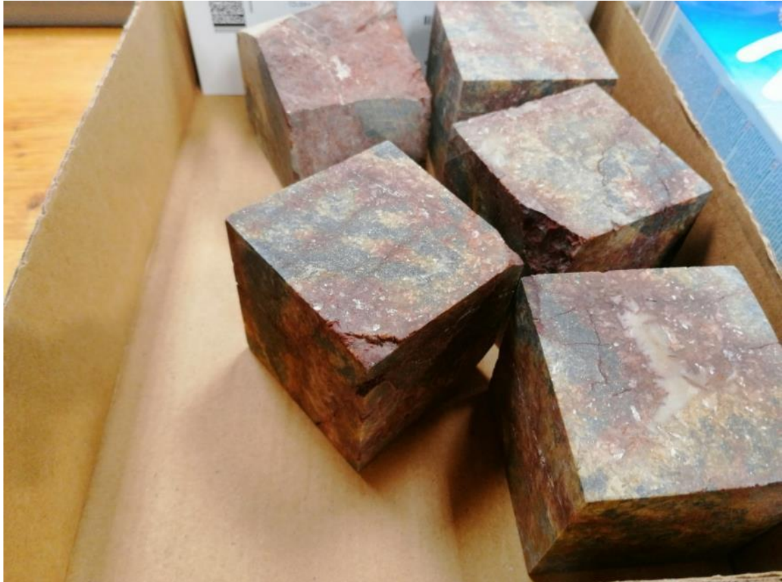
Slika 3-7. Uzorci odabrani za određivanje koeficijenta linearnog toplinskog širenja stijene.
