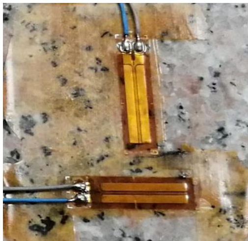
Slika 3-14. Zalijepljene mjerne trake.
