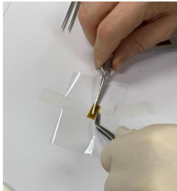
**Slika 3-9.** Nanošenje trake na prozirnu foliju
