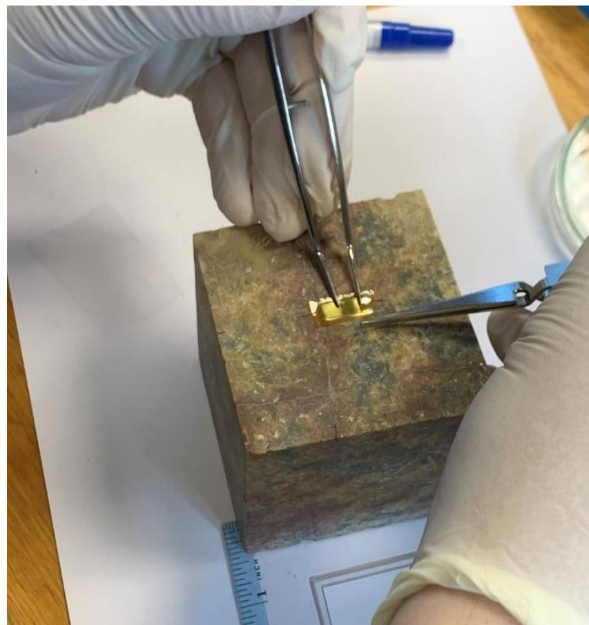
**Slika 3-13.** Postupak lijepljenja mjerne trake.
