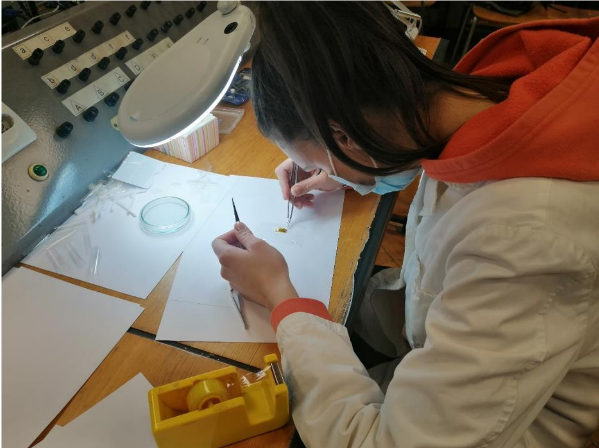
Slika 3-11. Priprema elektrootpornih mjernih traka.
