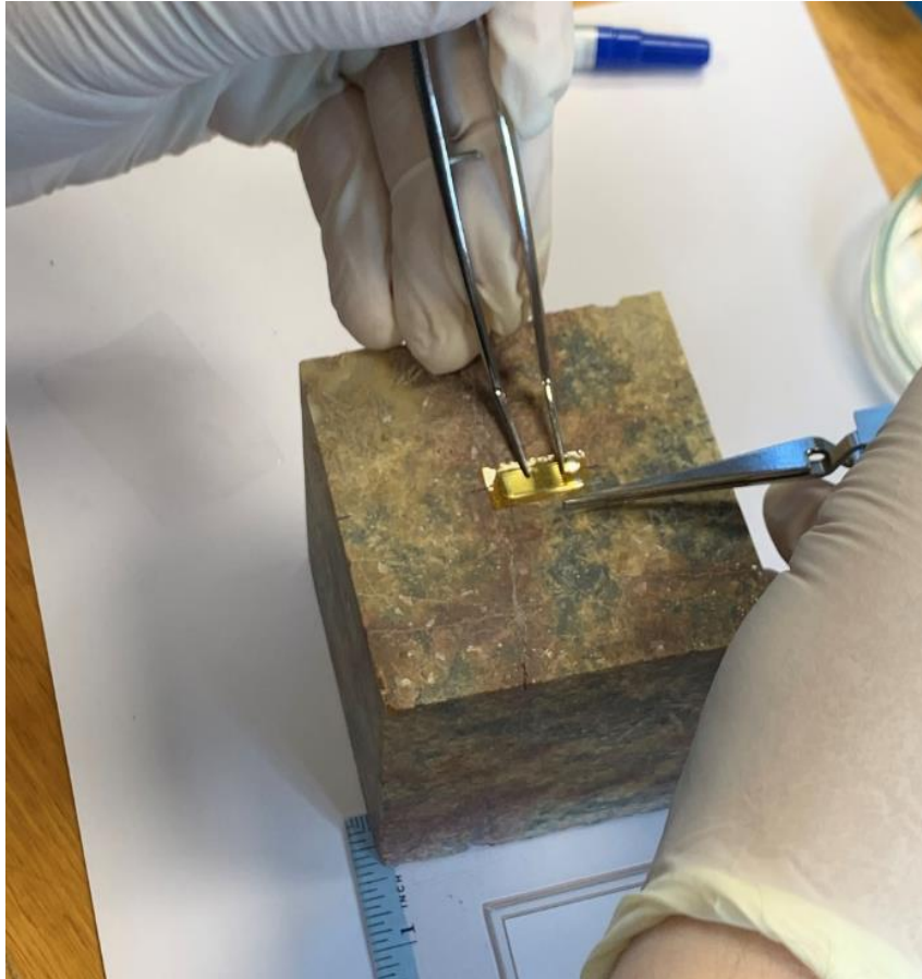
Slika 3-13. Postupak lijepljenja mjerne trake.
