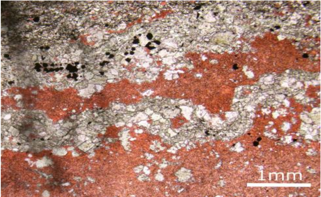
Slika 3.6. Mikrofotografija uzorka s oznakom ID-11F prikazuje vertikalnu izmjenu vapnenačkih i dolomitnih lamina
