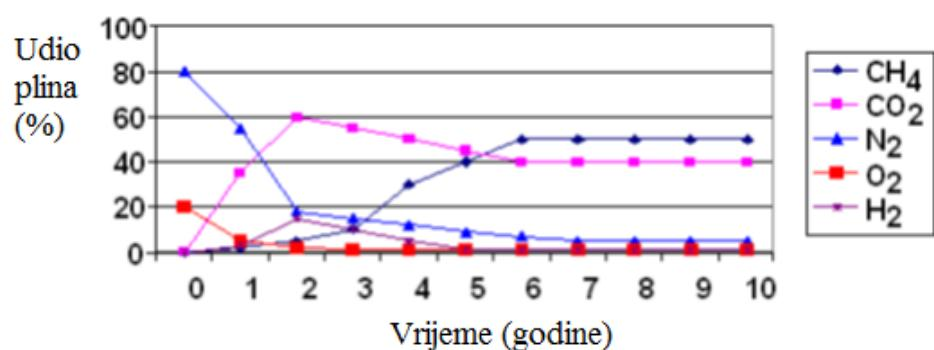
**Slika 3-6.** LFG sastav u odnosu na vrijeme za aerobnu i anaerobnu razgradnju otpada s odlagališta (U. S. Army Corps of Engineers 2008).
