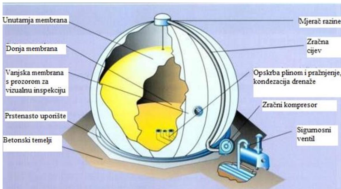
**Slika 3-4.** Spremnik za biopljin s dvostrukom membranom (Zafar 2015).
