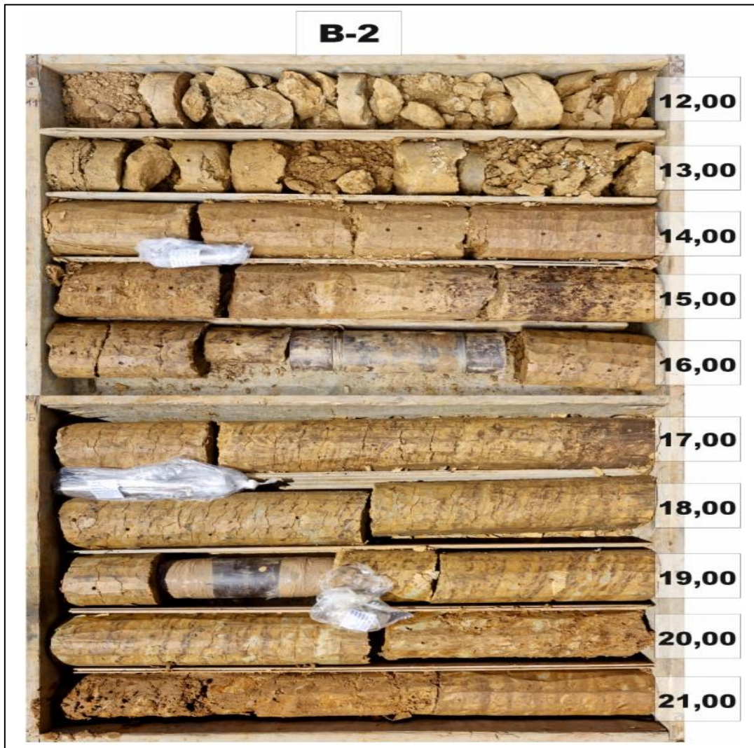
Slika 5-4. Glina visoke plastičnosti (CH) u intervalu od 14,5 m do 19,5 m dubine bušotine B2.
