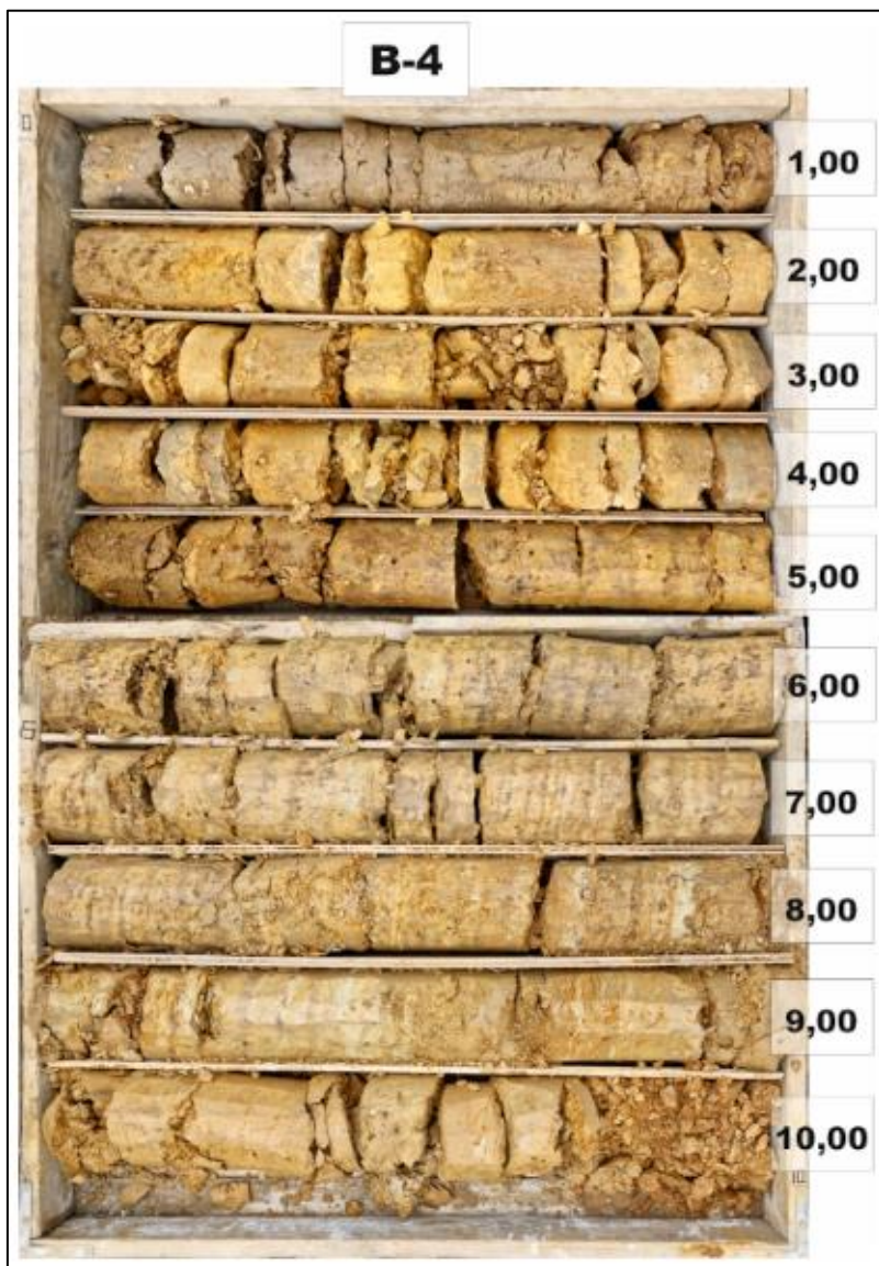
Slika 5-5. Glina niske plastičnosti (CL) u intervalu od 8 m do 9,7 m dubine bušotine B4.
