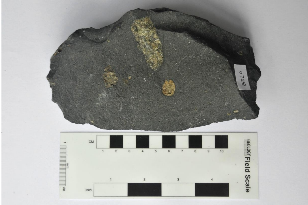
Slika 5-7 a: Bazalt s peridotitnim ksenolitima (BZL4)
