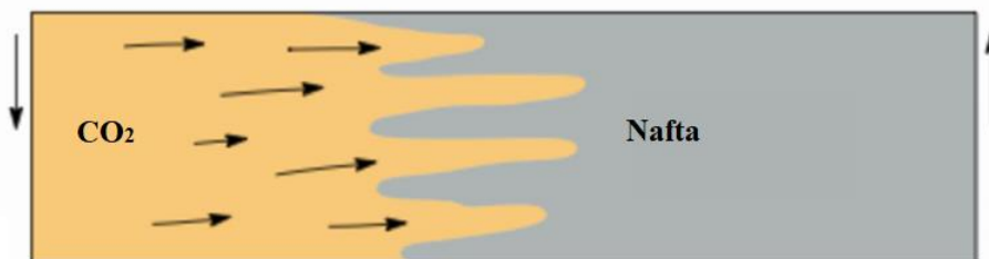
Slika 3-3. Nastalo prstoliko prodiranje CO 2 zbog njegove povećane mobilnosti u odnosu na naftu (Boait et al., 2015).
