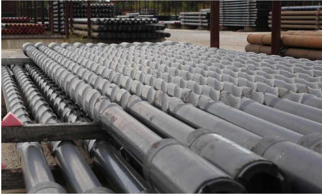
Slika 2-3. Spiralne teške šipke (www.nov.com, 2021)
