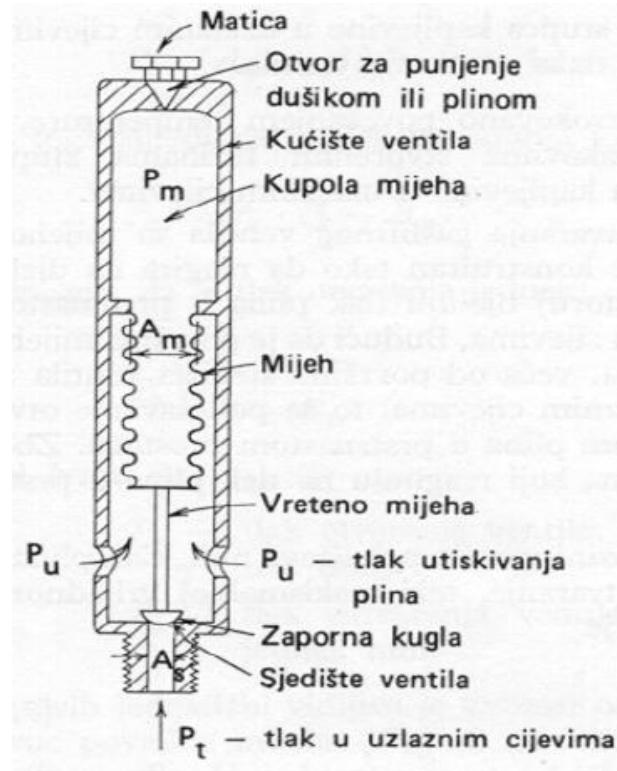
**Slika 3-3.** Shematski prikaz ventila s mijehom ispunjenim stlačenim plinom, bez opruge
