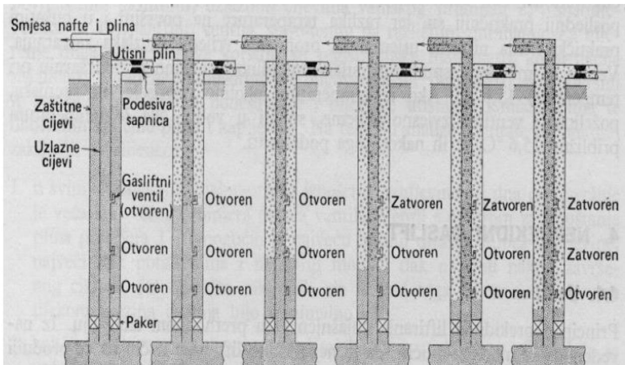
Slika 3-8. Rasterećivanje neprekidnog plinskog lifta (Zelić, 1977)
