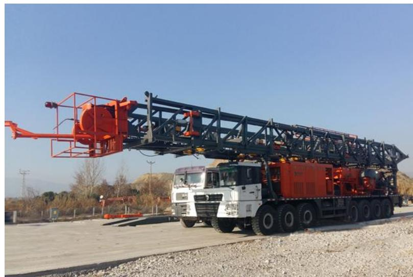
**Slika 2-4.** Pokretno kopneno bušaće postrojenje sa teleskopskim tornjem
