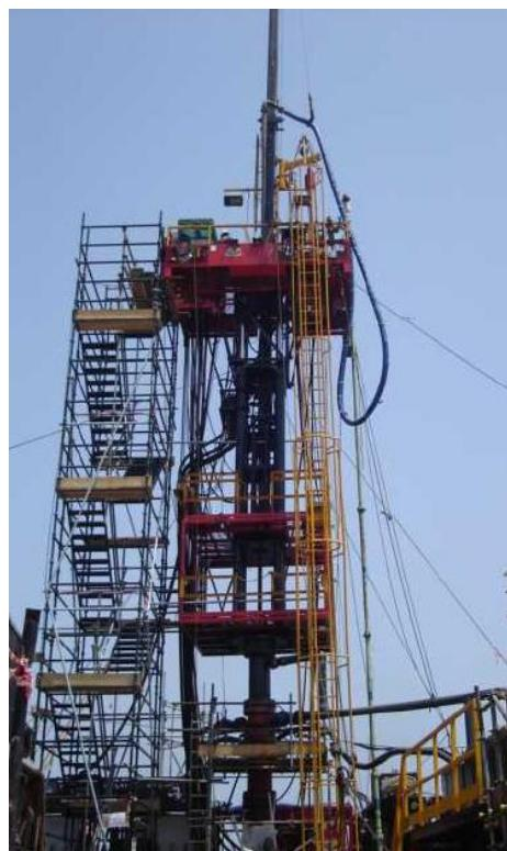
**Slika 4-3.** Prikaz hidrauličkog remontnog postrojenja tijekom bušenja s proizvodne platforme u odobalju (Huesecken, 2009)
