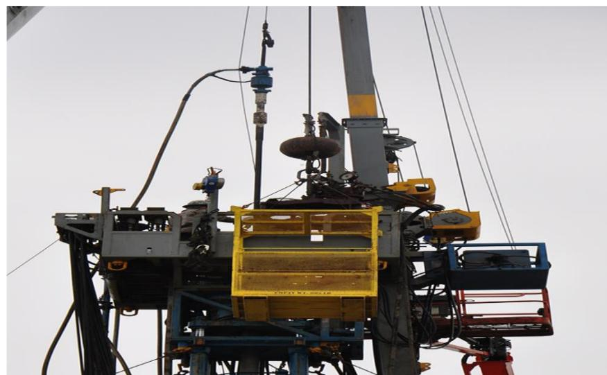
**Slika 3-15.** Prikaz isplačne glave i stojke na hidrauličkom remontnom postrojenju
