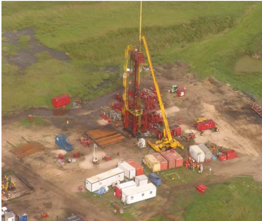
Slika 4-1. Prikaz hidrauličkog remontnog postrojenja na naftnom polju u Gabonu (Yunus et al., 2005)
