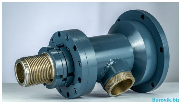
Slika 3-13. Prikaz isplačne glave koja se koristi na hidrauličkom remontnom postrojenju ( https://burovik.biz , 2018)
