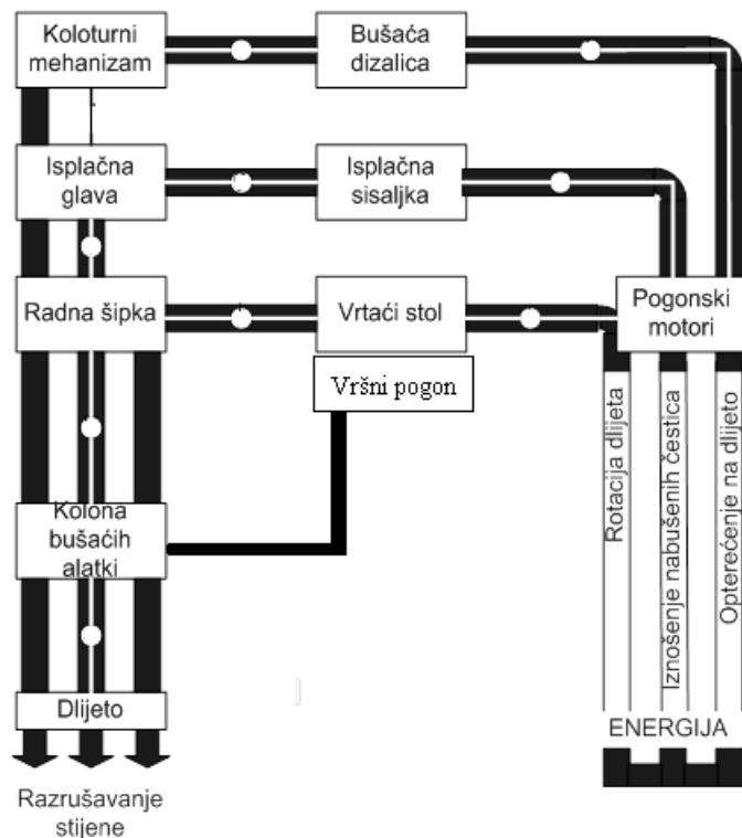
**Slika 2-5.** Shematski prikaz triju bitnih parametara rotacijske mehaničke metode bušenja (Matanović, 2006)
