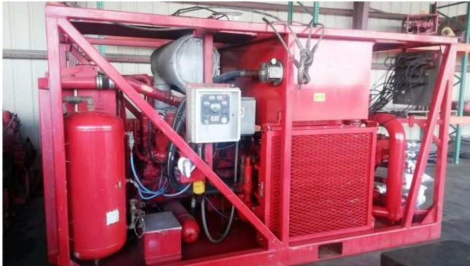
Slika 3-5. Prikaz dizelske pogonske jedinice (Skinner, 2019)
