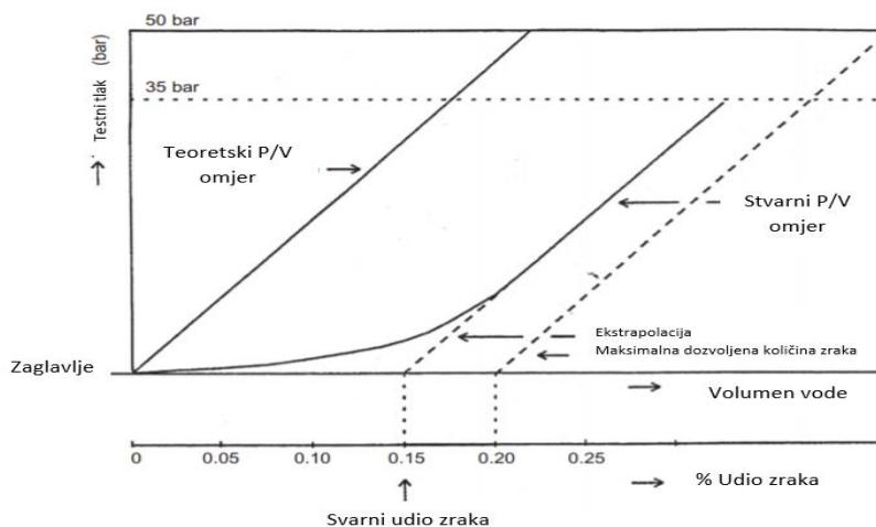
**Slika 5-1.** Određivanje volumena zraka u cjevovodu (Bahadori, 2017)
