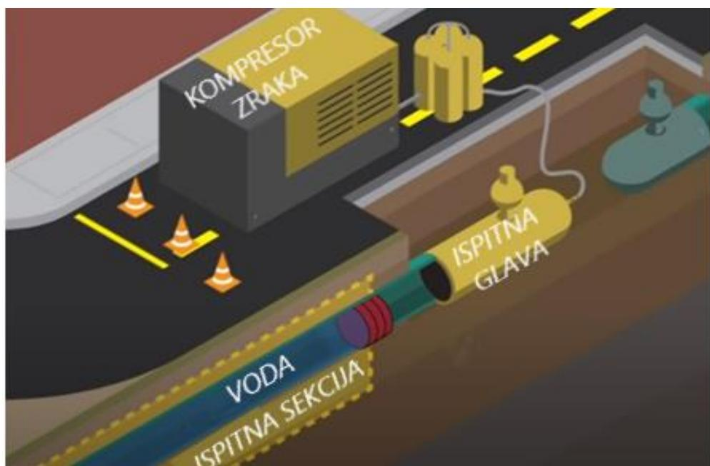
Slika 7-1. Oprema za odvodnjavanje i sušenje cjevovoda (SoCalGas, 2014)
