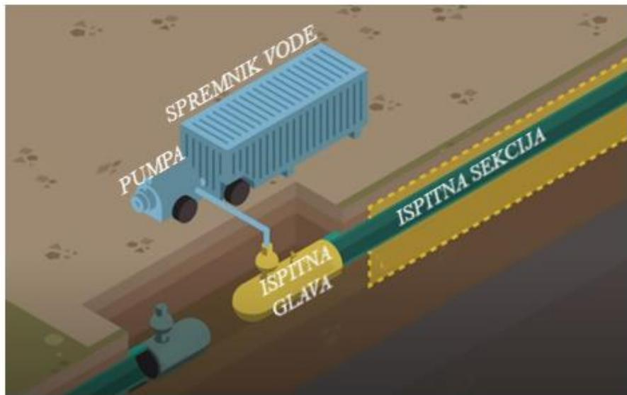
**Slika 2–1.** Oprema za punjenje cjevovoda vodom (SoCalGas, 2014)
