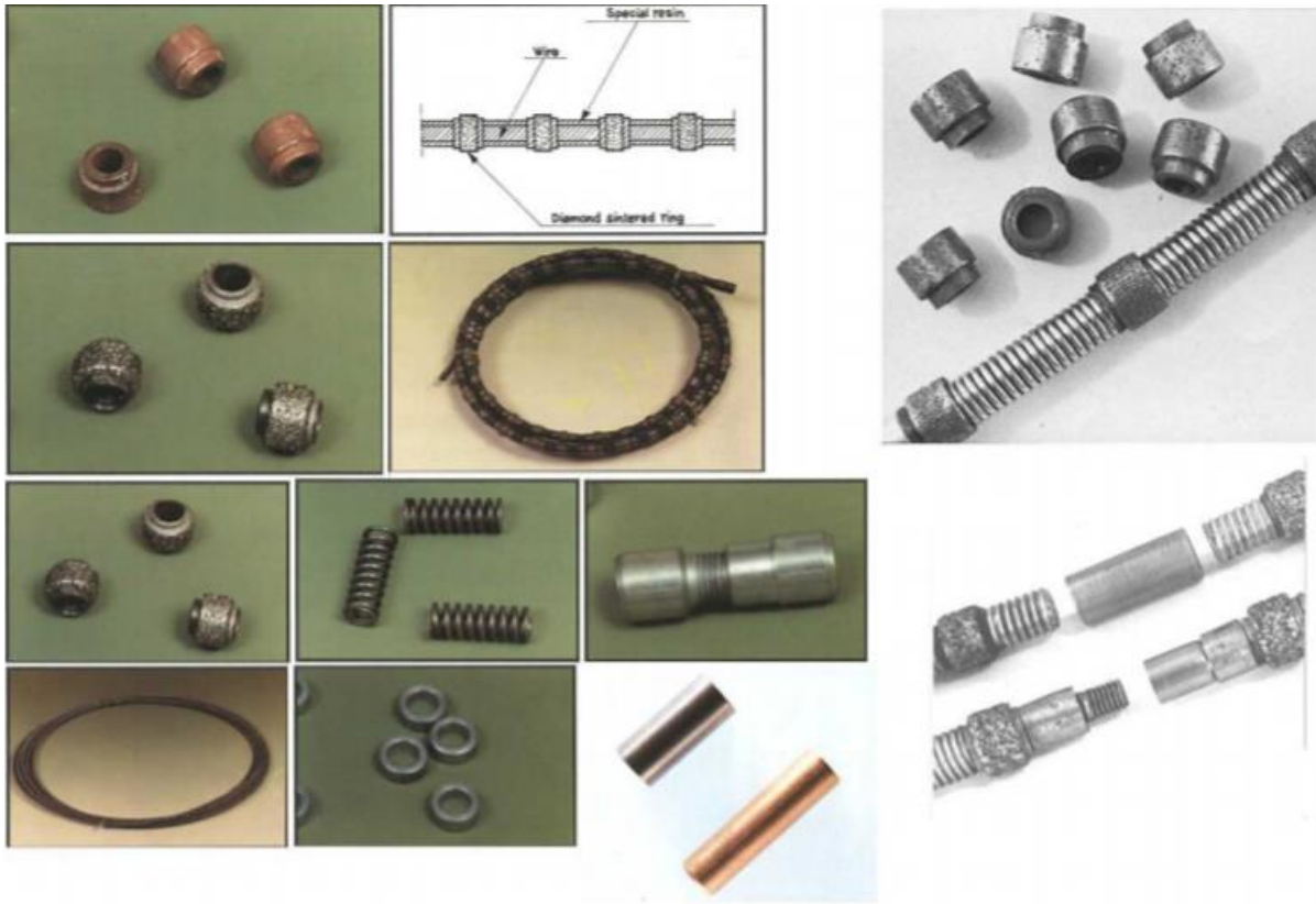
Slika 2-1 Elementi od kojih se formira dijamantna žica njihovim nanizivanjem na čelično užje (Dunda i Kujundžić, 2003)
