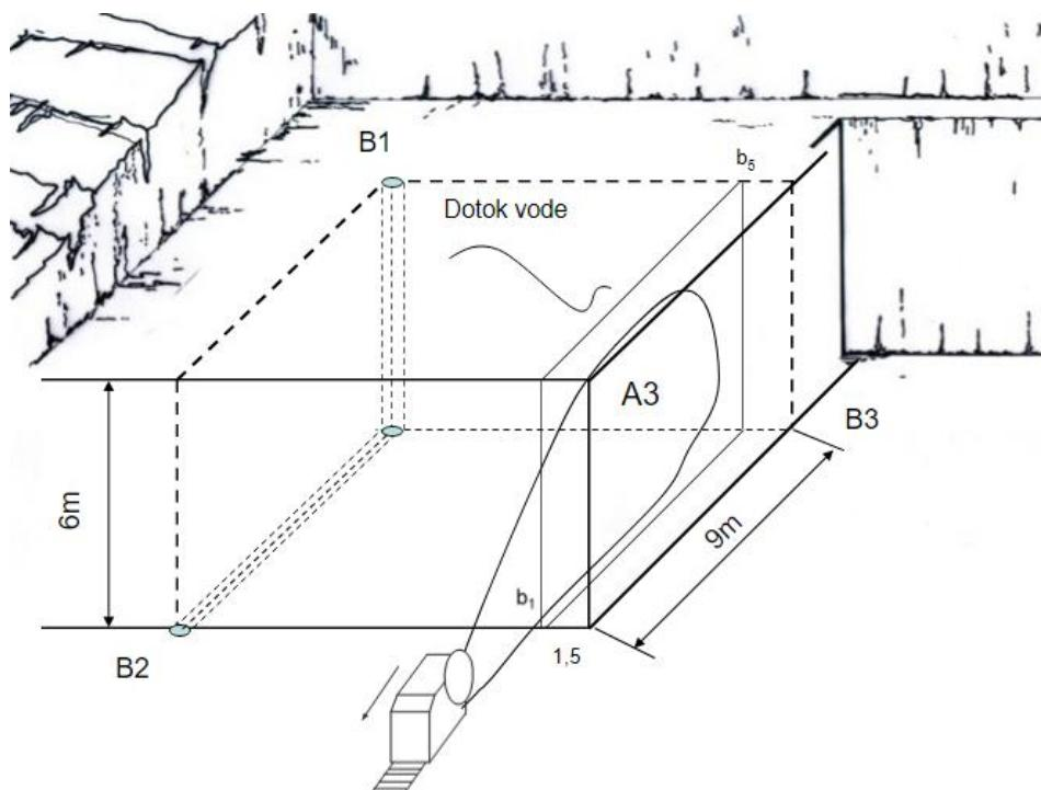
**Slika 2-5** Izrada stražnjeg vertikalnog reza (Korman, 2014)
