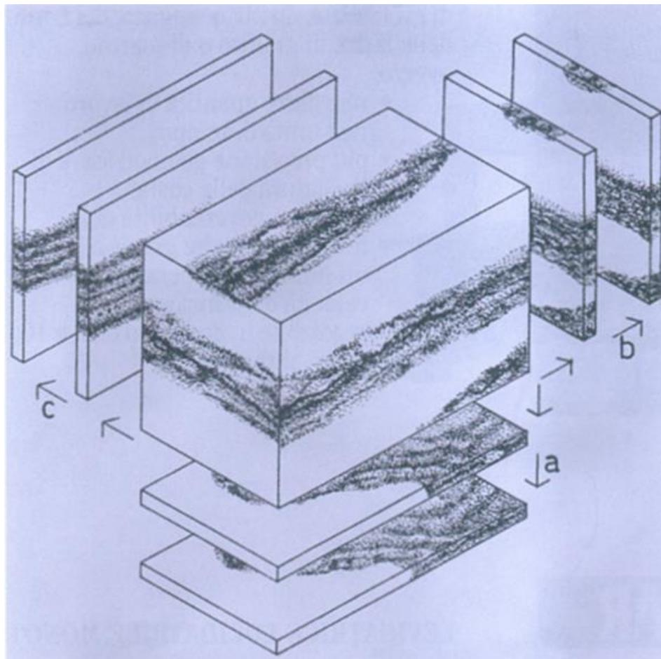
Slika 4-2 Smjerovi piljenja u odnosu na slojevitost (Dunda, 2006)
