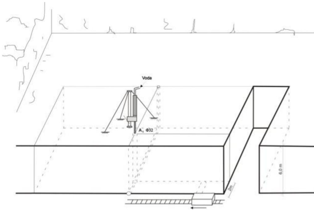
Slika 2-8 Izrada horizontalnog reza i pripremne radnje (Korman, 2014)
