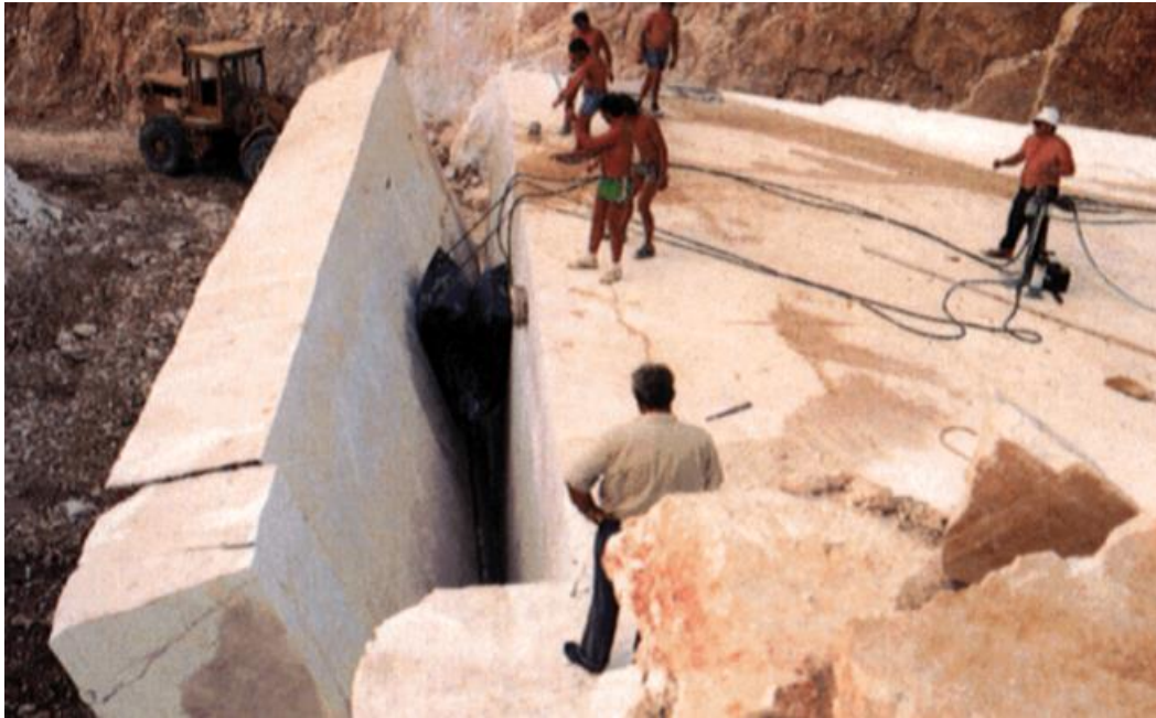
Slika 2-10 Obaranje primarnog bloka pomoću zračnih jastuka u kamenolomu Kanfanar (Dunda i Kujundžić, 2003)
