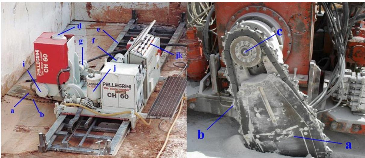
Slika 2-7 Osnovni dijelovi lančane sjekačice (Korman i Kujundžić, 2014)
