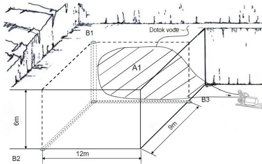
Slika 2-3 Izrada bočnog vertikalnog reza (Korman, 2014)
