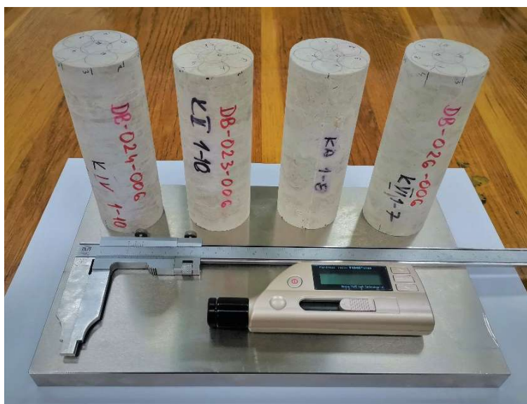
Slika 3-5 Ispitni uređaji i uzorci vapnenca na metalnoj podlozi
