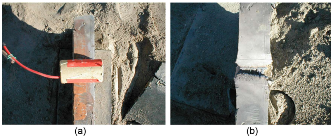
Slika 3-5. Linijski kumulativni nabojaj: a) kumulativni rezač i b) njegov učinak na čeliku (Duan et al., 2017)
