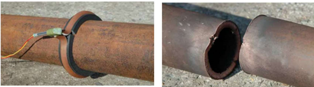
Slika 3-6. Savitljivi linijski kumulativni rezač i cijev prerezana njegovom detonacijom (Bohanek, 2013)
