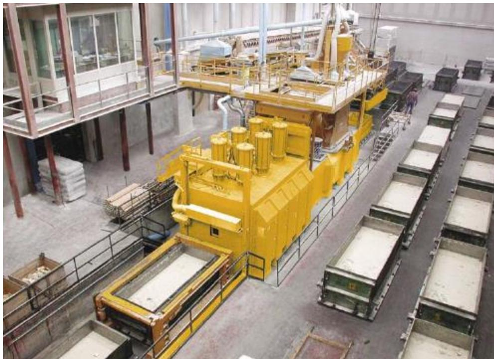
Slika 4-5. Vibro kompresijska vakuum komora i kalupi (Bretonstone, 2020)
