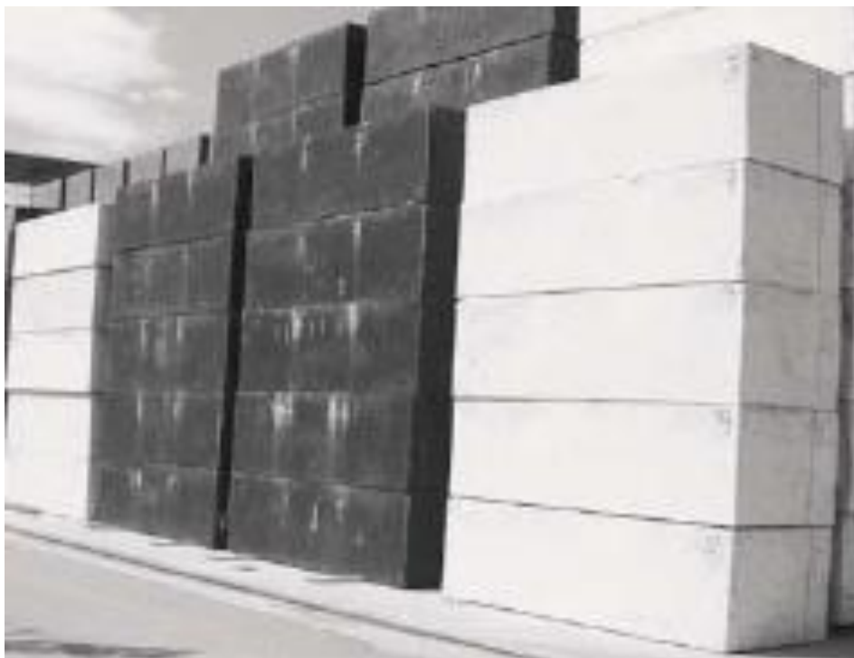
Slika 4-4. Breton blokovi dimenzija 308x125x88 (Bretonstone, 2020)
