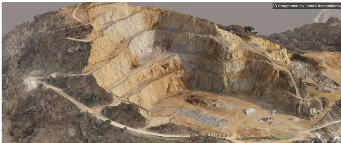
Slika 3-3:3D Fotogrametrijski model kamenoloma
