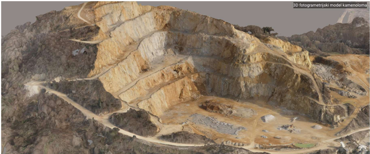
Slika 3-3:3D Fotogrametrijski model kamenoloma
