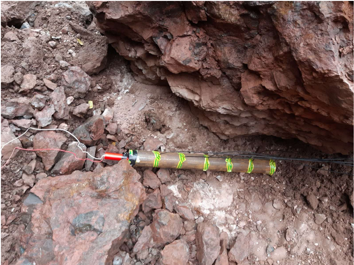
Slika 5-4. Prikaz eksplozivnog naboja u čeličnoj cijevi i optičkim vlaknima kao sensorima
