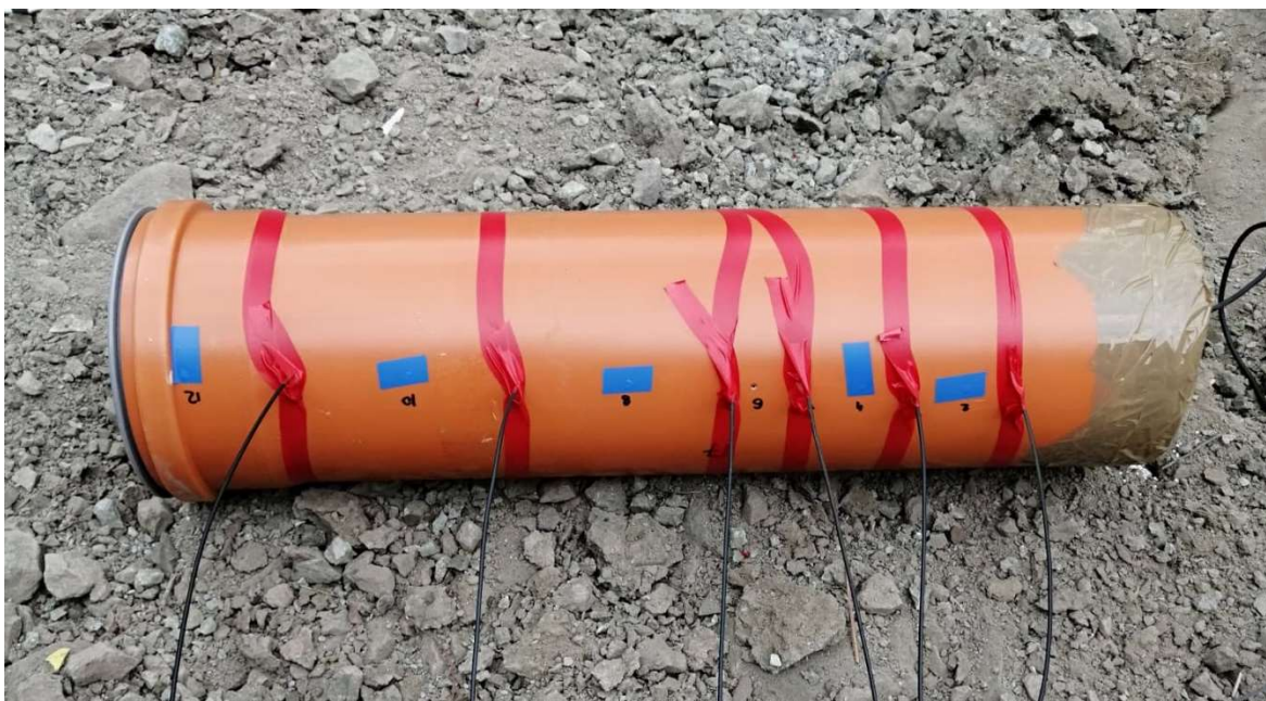
Slika 5-3. Prikaz eksplozivnog naboja u PVC cijevi i optičkim vlaknima kao senzorima
