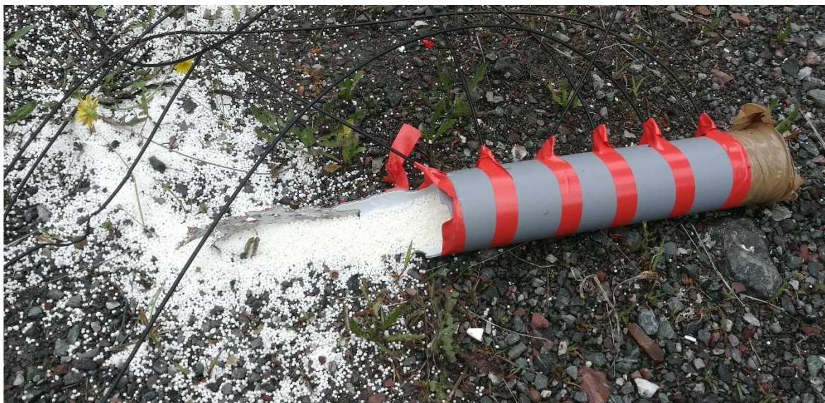
Slika 6-1. Prekid detonacije kod naboja promjera 50 mm.
