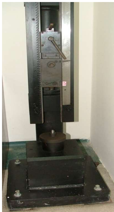
Slika 2-7. BAM uređaj za određivanje osjetljivosti eksploziva na udar.
