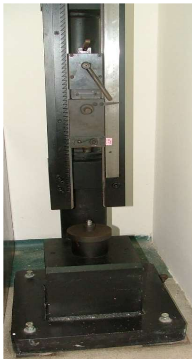
Slika 2-7. BAM uređaj za određivanje osjetljivosti eksploziva na udar.
