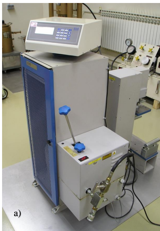
Slika 3-1 a) hidraulična preša „ADR 2000“, b) okvir za opterećenje na savijanje
