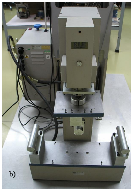
Slika 3-1 a) hidraulična preša „ADR 2000“, b) okvir za opterećenje na savijanje
