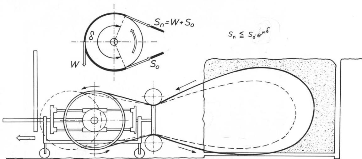
Slika 3-4: Piljenje vertikalnog reza (Dunda i Kujundžić, 2003.)
