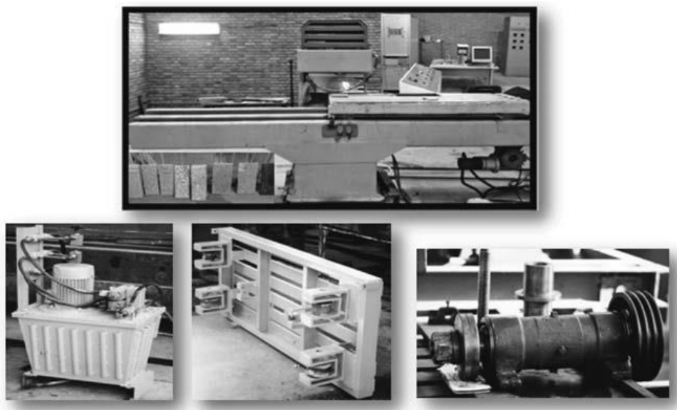
Slika 2-4: Laboratorijski stroj za rezanje (Mikaeil i dr., 2018.)
