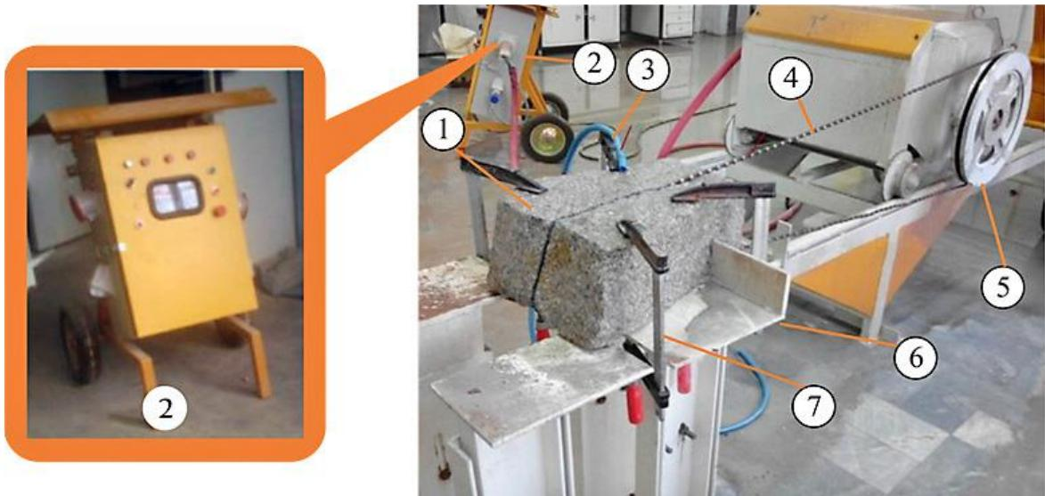
Slika 2-1: Laboratorijski stroj za rezanje (Khoshouei i dr., 2020.): 1 – Uzorak stijene; 2 – Jedinica za mjerjenje potrošnje energije; 3 – Jedinica za dotok vode; 4 – Dijamantna žica; 5 – Pogonski kotač
