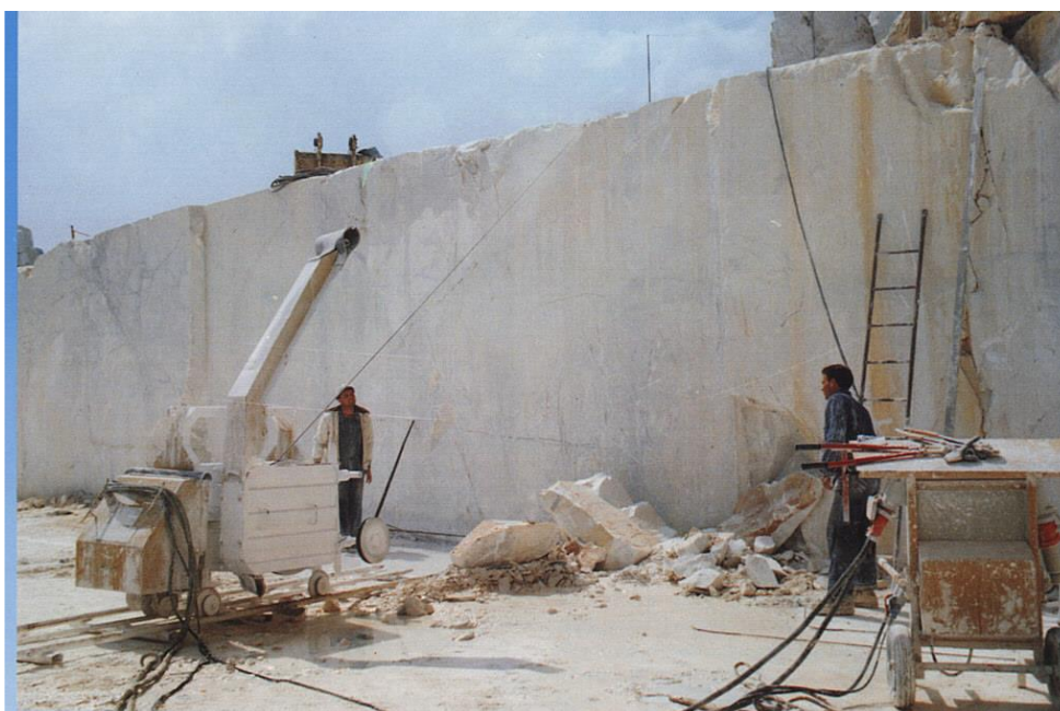
Slika 3-2: Automatska regulacija napinjanja žice (Dunda i Kujundžić, 2003.)
