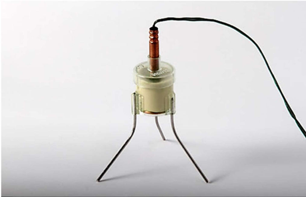
Slika 2-1 Kumulativni perforator (Martin 2021)
