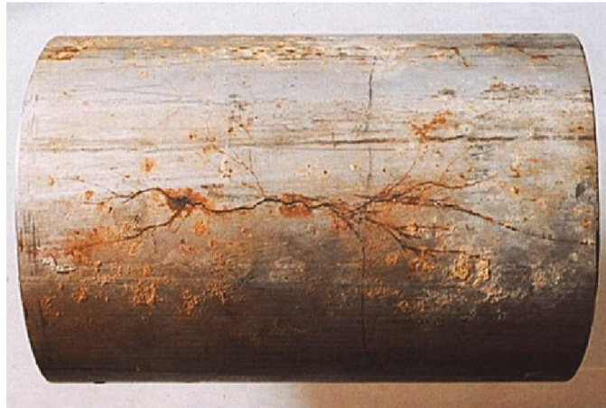
Slika 2-10. Primjer napetosne korozije/korozijskog raspucavanja uz naprezanje (Rudling, 2007.)
