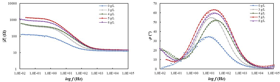
Slika 5-34. Bodeov prikaz podataka snimljenih na uzorku ugljičnog čelika u simuliranoj slojnoj vodi zasićenoj s  $\text{CO}_2$  u protočnim uvjetima za različite koncentracije ekstrakta cvijeta vrkute
