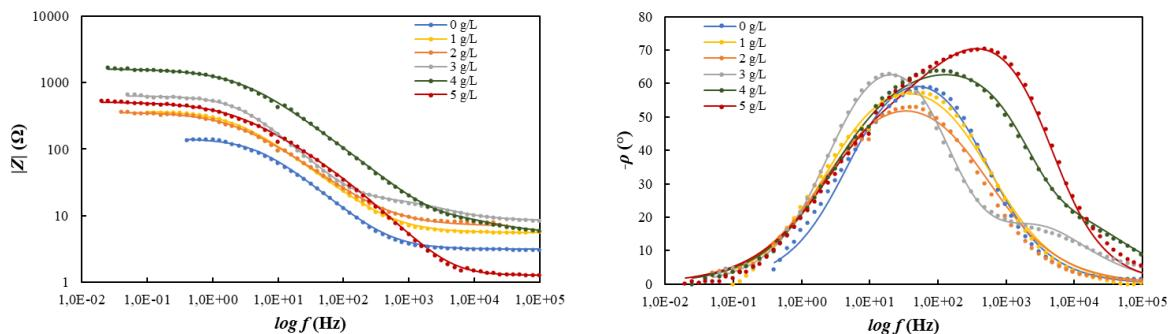
Slika 5-31. Bodeov prikaz podataka snimljenih na uzorku ugljičnog čelika u simuliranoj slojnoj vodi zasićenoj s  $\text{CO}_2$  za različite koncentracije ekstrakta cvijeta vrkute
