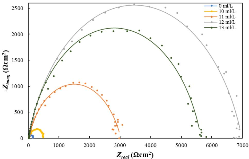
Slika 5-36. Nyquistov prikaz podataka snimljenih na uzorku ugljičnog čelika u simuliranoj slojnoj vodi zasićenoj s  $\text{CO}_2$  za različite koncentracije ekstrakta korijena maslačka
