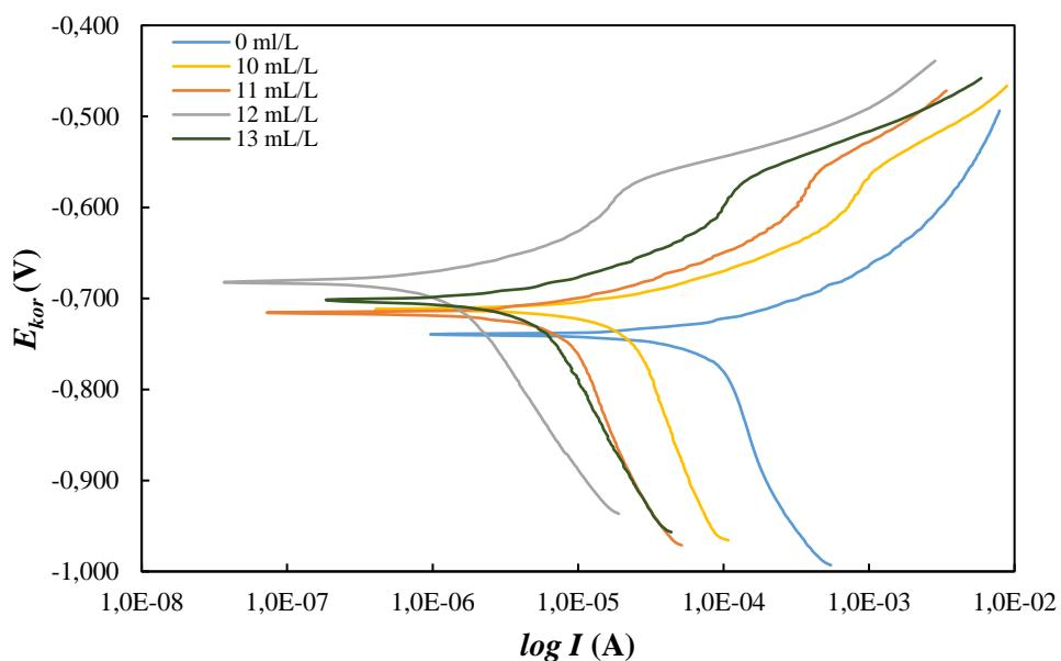
Slika 5-35. Polarizacijske krivulje snimljene na uzorku ugljičnog čelika u simuliranoj slojnoj vodi zasićenoj s CO<sub>2</sub> bez i u prisutnosti različitih koncentracija ekstrakta korijena maslačka
