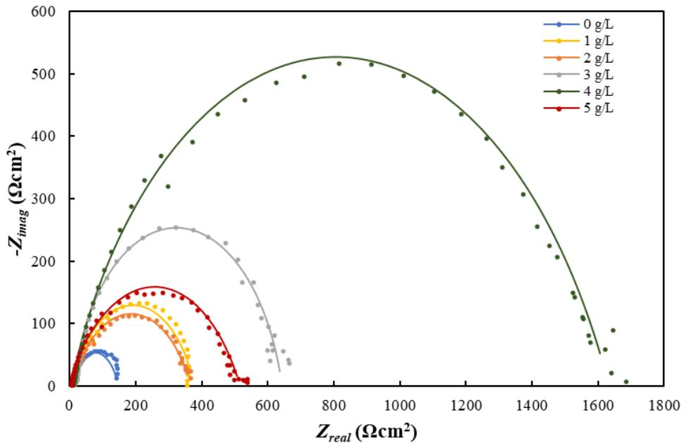
Slika 5-30. Nyquistov prikaz podataka snimljenih na uzorku ugljičnog čelika u simuliranoj slojnoj vodi zasićenoj s  $\text{CO}_2$  za različite koncentracije ekstrakta cvijeta vrkute
