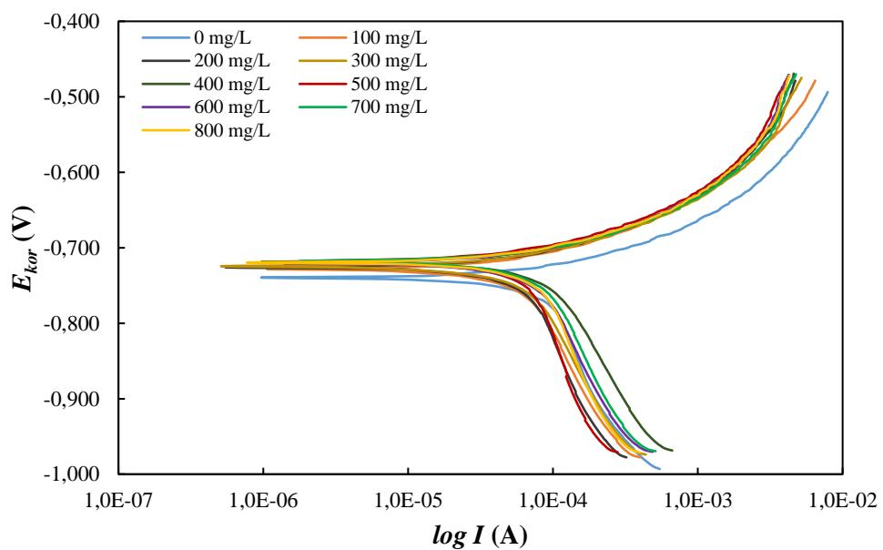
Slika 5-7. Polarizacijske krivulje snimljene na uzorku ugljičnog čelika u simuliranoj slojnoj vodi zasićenoj s CO<sub>2</sub> za različite koncentracije ekstrakta korijena sladića
