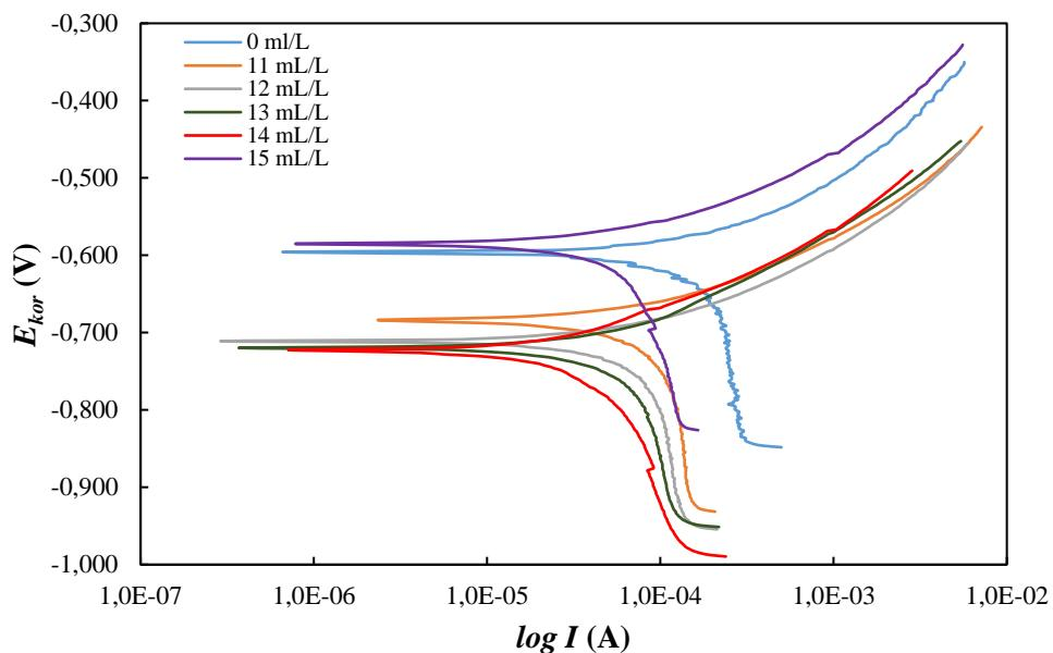
Slika 5-38. Polarizacijske krivulje snimljene na uzorku ugljičnog čelika u simuliranoj slojnoj vodi zasićenoj s CO<sub>2</sub> u protočnim uvjetima bez i u prisutnosti različitih koncentracija ekstrakta korijena maslačka
