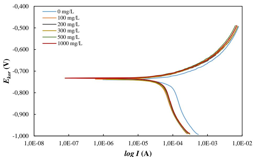
Slika 5-14. Polarizacijske krivulje snimljene na uzorku ugljičnog čelika u simuliranoj slojnoj vodi zasićenoj s  $\text{CO}_2$  za koncentracije ekstrakta korijena maslačka do 1000 mg/L
