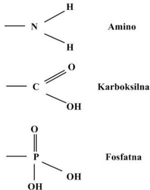
Slika 2-17. Mehanizmi djelovanja organskih inhibitora korozije i njihove funkcionalne grupe
