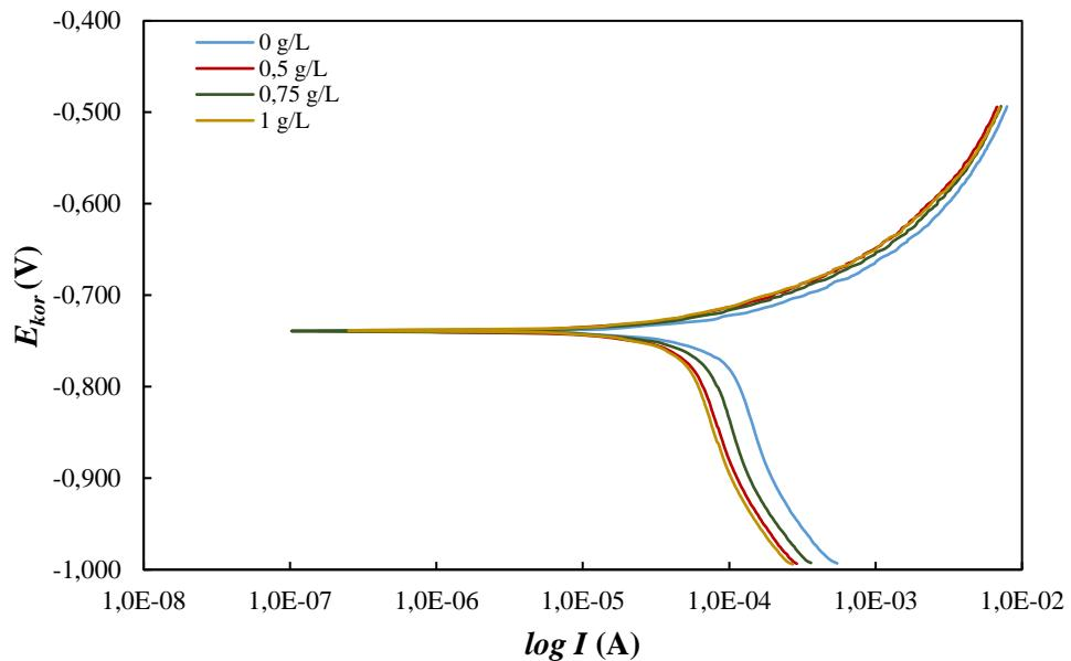
Slika 5-11. Polarizacijske krivulje snimljene na uzorku ugljičnog čelika u simuliranoj slojnoj vodi zasićenoj s CO<sub>2</sub> za koncentracije ekstrakta tropa grožđa do 1 g/L
