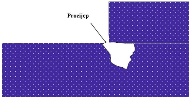
Slika 2-7. Primjer geometrije korozije u procijepu (prema Papavinasam, 2014.)
