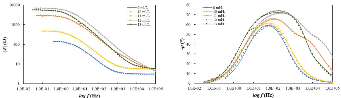
Slika 5-37. Bodeov prikaz podataka snimljenih na uzorku ugljičnog čelika u simuliranoj slojnoj vodi zasićenoj s  $\text{CO}_2$  za različite koncentracije ekstrakta korijena maslačka
