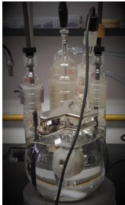
Slika 4-1. Troelektrodna elektrolitska čelija za ispitivanje u stacionarnim uvjetima
