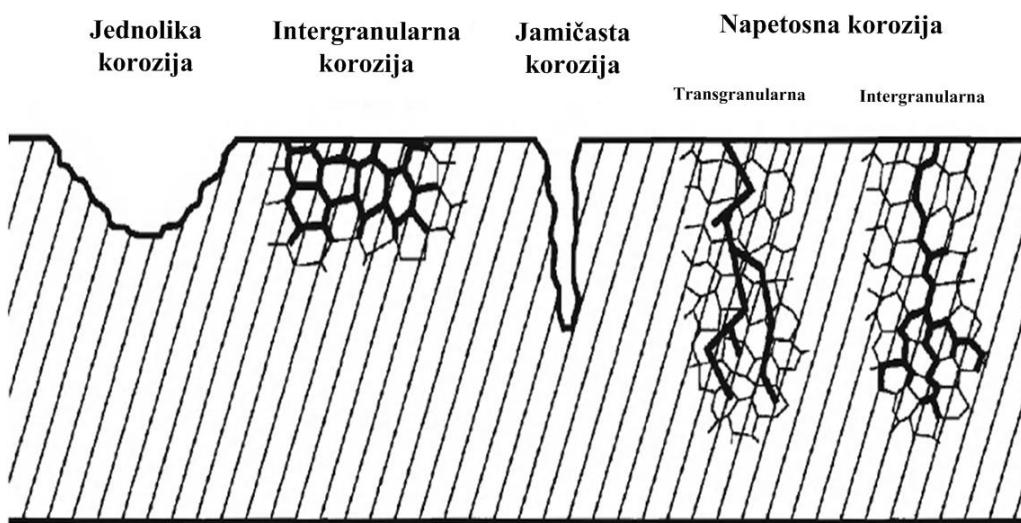
Slika 2-3. Shematski prikaz pojedinih oblika korozije (Staehle, 2011.)
