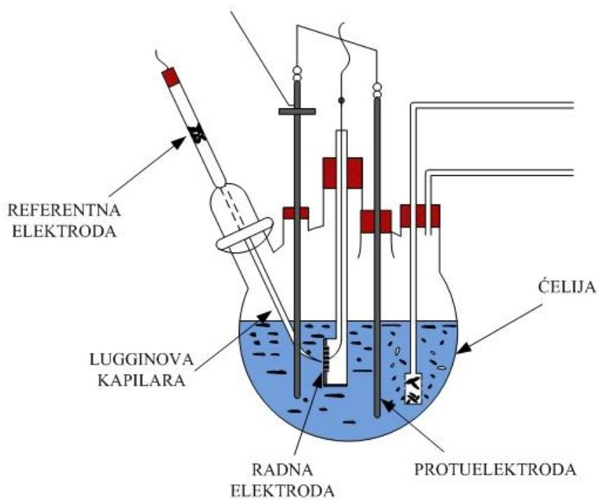
Slika 2-18. Troelektrodna korozijačka čelijska skica (Sastri, 2011.)
