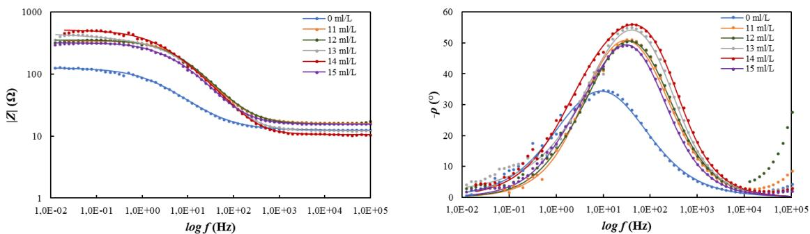
Slika 5-40. Bodeov prikaz podataka snimljenih na uzorku ugljičnog čelika u simuliranoj slojnoj vodi zasićenoj s  $\text{CO}_2$  u protočnim uvjetima za različite koncentracije ekstrakta korijena maslačka
