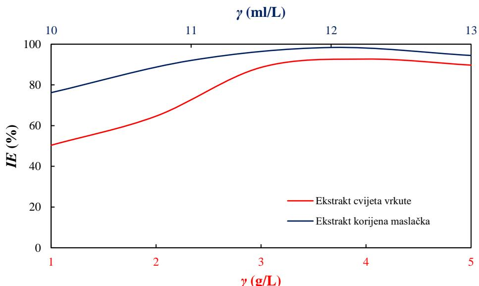
Slika 5-41. Usporedba djelotvornosti ekstrakta cvijeta vrkute i ekstrakta korijena maslačka dobivenih potenciodinamičkom metodom s Tafelovom extrapolacijom u stacionarnim uvjetima
