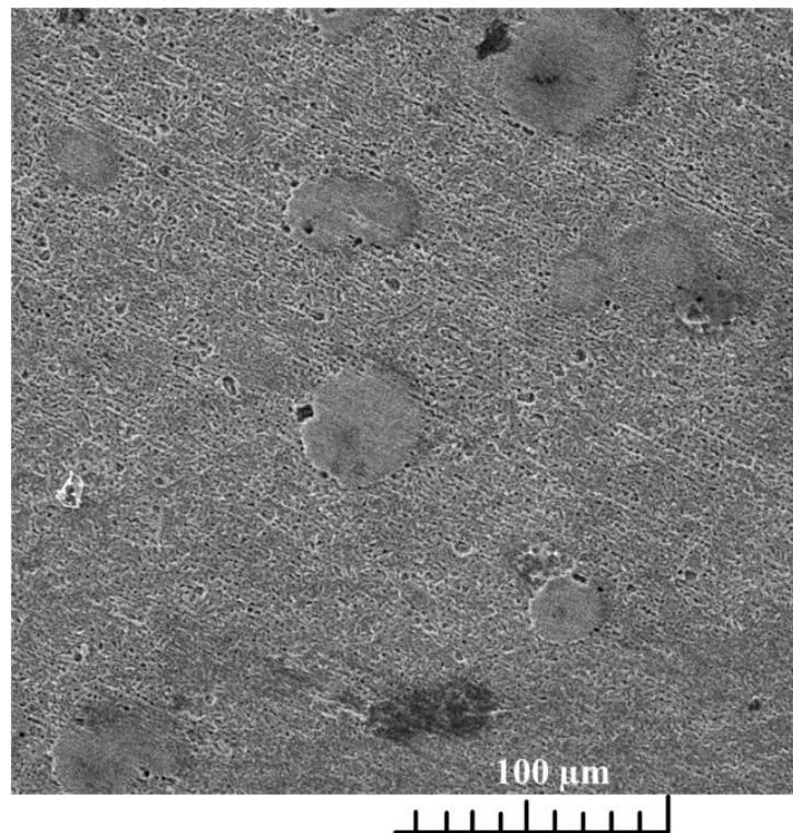
Slika 5-47. SEM snimka površine uzorka ugljičnog čelika snimljena nakon 4 sata izlaganja sintetskoj slojnoj vodi zasićenoj s CO<sub>2</sub>
