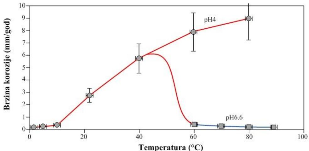
Slika 2-12. Utjecaj temperature na brzinu korozije (Nešić, 2011.)
