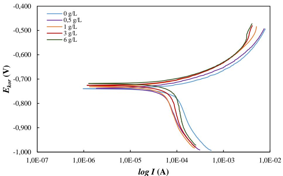
Slika 5-17. Polarizacijske krivulje snimljene na uzorku ugljičnog čelika u simuliranoj slojnoj vodi zasićenoj s  $\text{CO}_2$  za različite koncentracije ekstrakta čuvarkuće
