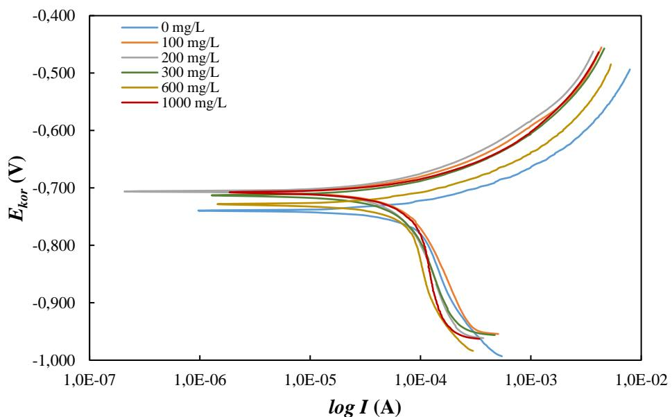
Slika 5-1. Polarizacijske krivulje snimljene na uzorku ugljičnog čelika u simuliranoj slojnoj vodi zasićenoj s CO<sub>2</sub> za različite koncentracije ekstrakta šipka
