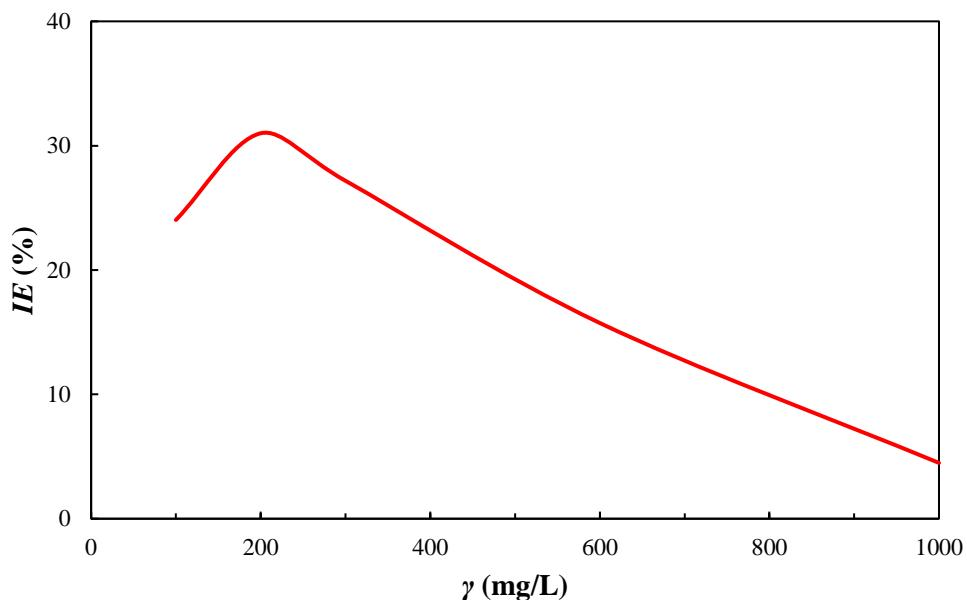
Slika 5-2. Inhibitorska djelotvornost ekstrakta šipka u ovisnosti o koncentraciji
