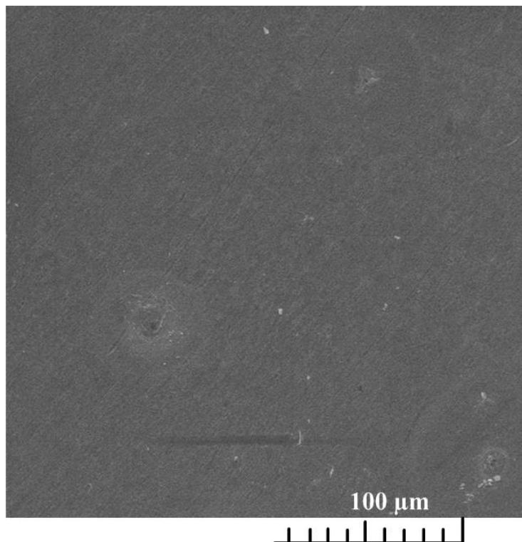
Slika 5-48. SEM snimka površine uzorka ugljičnog čelika snimljena nakon 4 sata izlaganja sintetskoj slojnoj vodi zasićenoj s CO<sub>2</sub> u prisutnosti 4 g/L ekstrakta cvijeta vrkute
