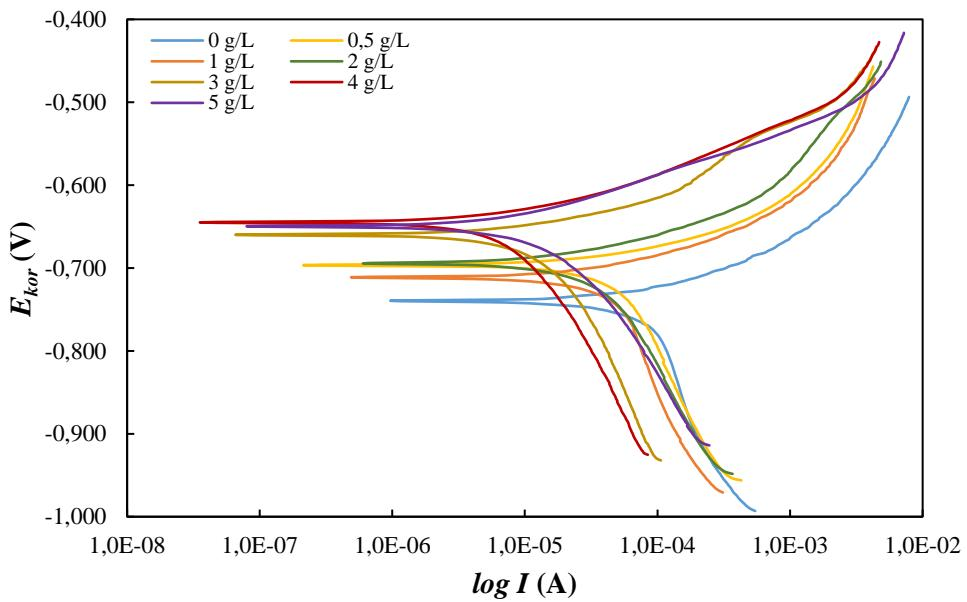
Slika 5-21. Polarizacijske krivulje snimljene na uzorku ugljičnog čelika u simuliranoj slojnoj vodi zasićenoj s CO<sub>2</sub> za različite koncentracije ekstrakta cvijeta vrkute
