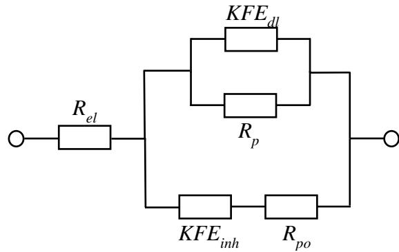
Slika 4-4. Ekvivalentni električni krug za inhibirani sustav (a)
