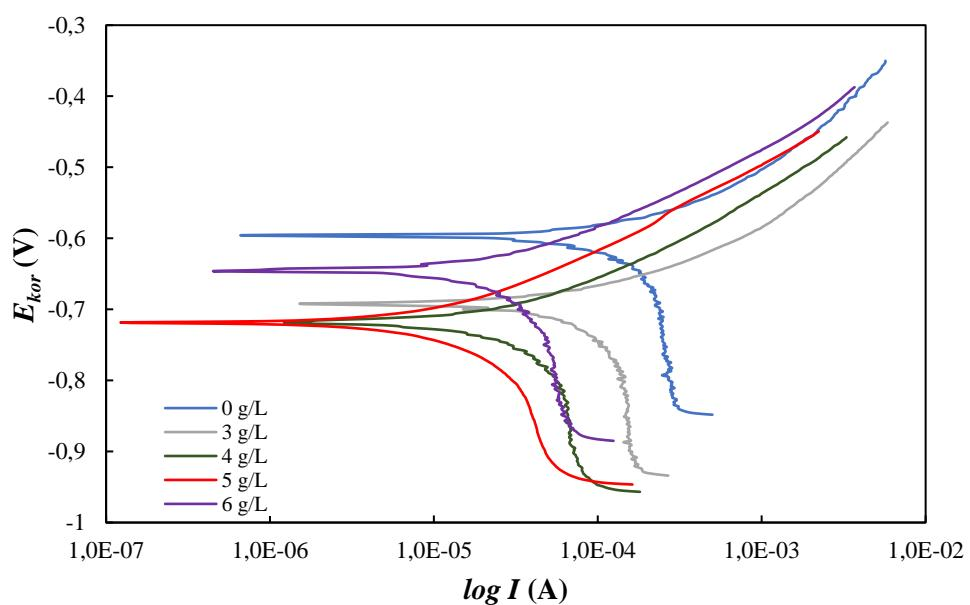
Slika 5-32. Polarizacijske krivulje snimljene na uzorku ugljičnog čelika u simuliranoj slojnoj vodi zasićenoj s CO<sub>2</sub> u protočnim uvjetima bez i u prisutnosti različitih koncentracija ekstrakta cvijeta vrkute
