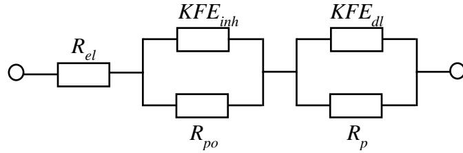
Slika 4-5. Ekvivalentni električni krug za inhibirani sustav (b)
