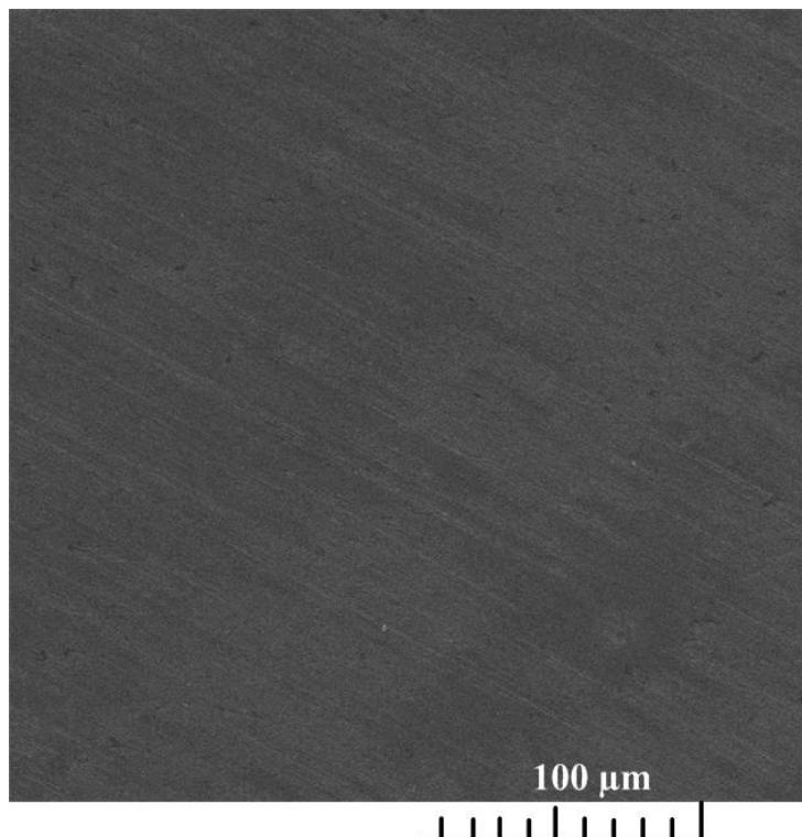
Slika 5-49. SEM snimka površine uzorka ugljičnog čelika snimljena nakon 4 sata izlaganja sintetskoj slojnoj vodi zasićenoj s  $\text{CO}_2$  u prisutnosti 12 mL/L ekstrakta korijena maslačka
