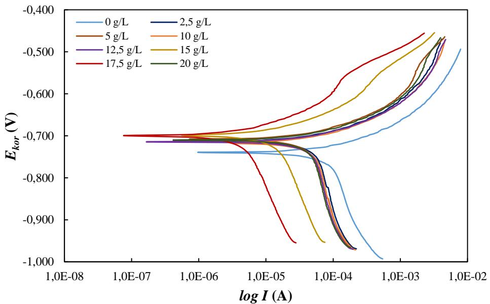
Slika 5-15. Polarizacijske krivulje snimljene na uzorku ugljičnog čelika u simuliranoj slojnoj vodi zasićenoj s  $\text{CO}_2$  za koncentracije ekstrakta korijena maslačka iznad 1 g/L
