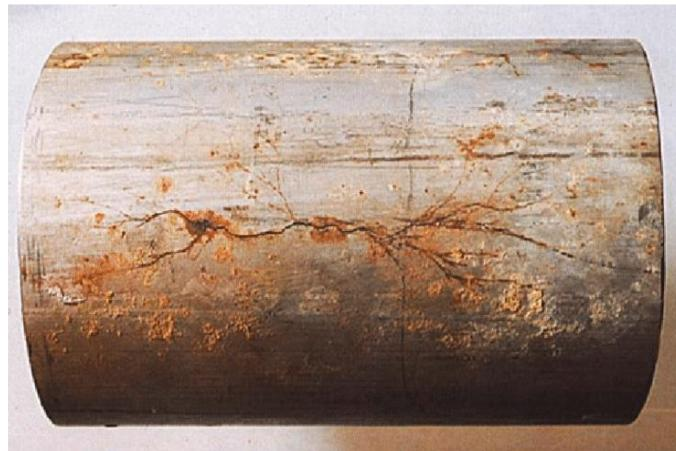
Slika 2-10. Primjer napetosne korozije/koroziskog raspucavanja uz naprezanje (Rudling, 2007.)
