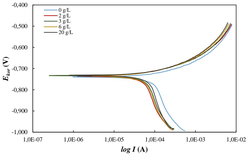
Slika 5-12. Polarizacijske krivulje snimljene na uzorku ugljičnog čelika u simuliranoj slojnoj vodi zasićenoj s CO<sub>2</sub> za koncentracije ekstrakta tropa grožđa iznad 1 g/L
