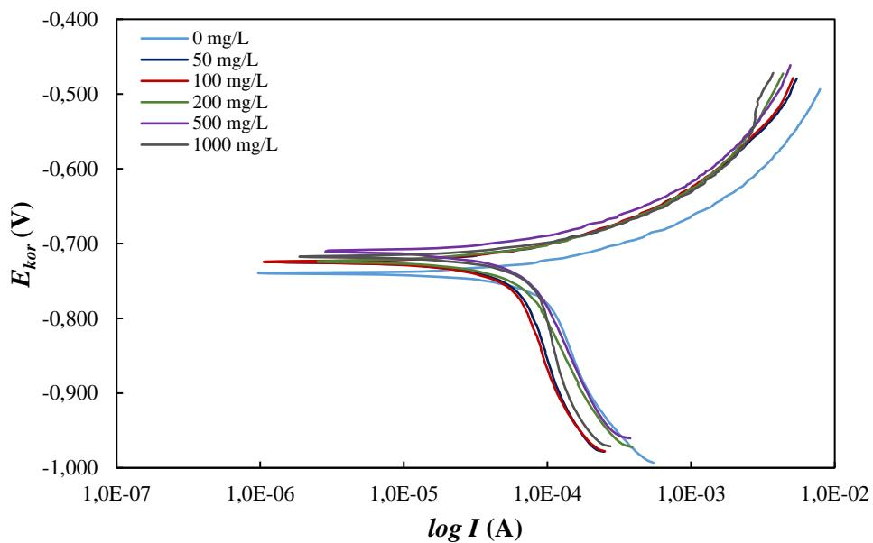
Slika 5-3. Polarizacijske krivulje snimljene na uzorku ugljičnog čelika u simuliranoj slojnoj vodi zasićenoj s CO<sub>2</sub> za različite koncentracije ekstrakta matičnjaka
