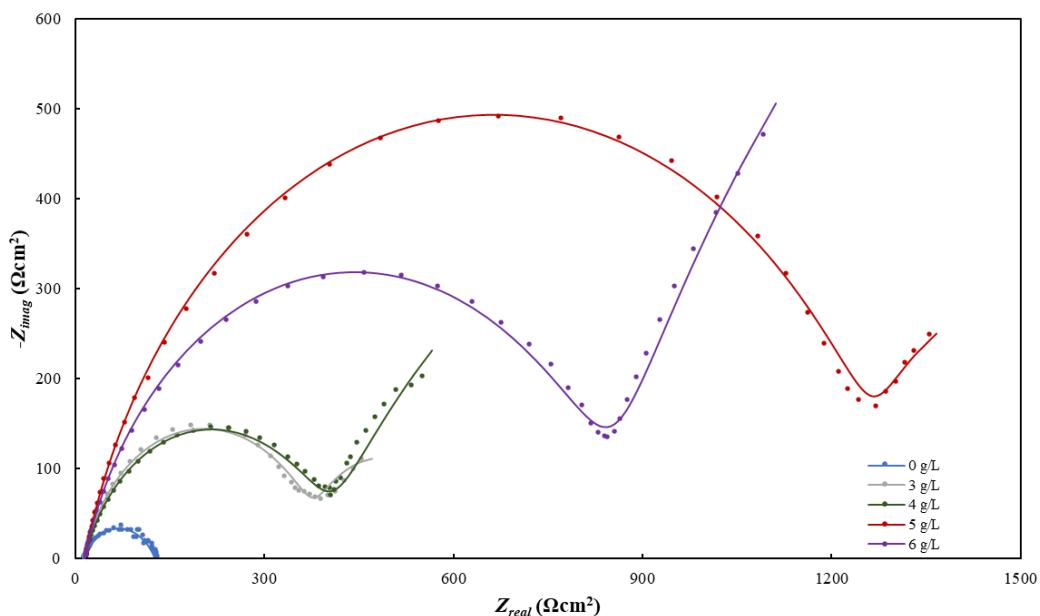
Slika 5-33. Nyquistov prikaz podataka snimljenih na uzorku ugljičnog čelika u simuliranoj slojnoj vodi zasićenoj s CO<sub>2</sub> u protočnim uvjetima za različite koncentracije ekstrakta cvijeta vrkute
