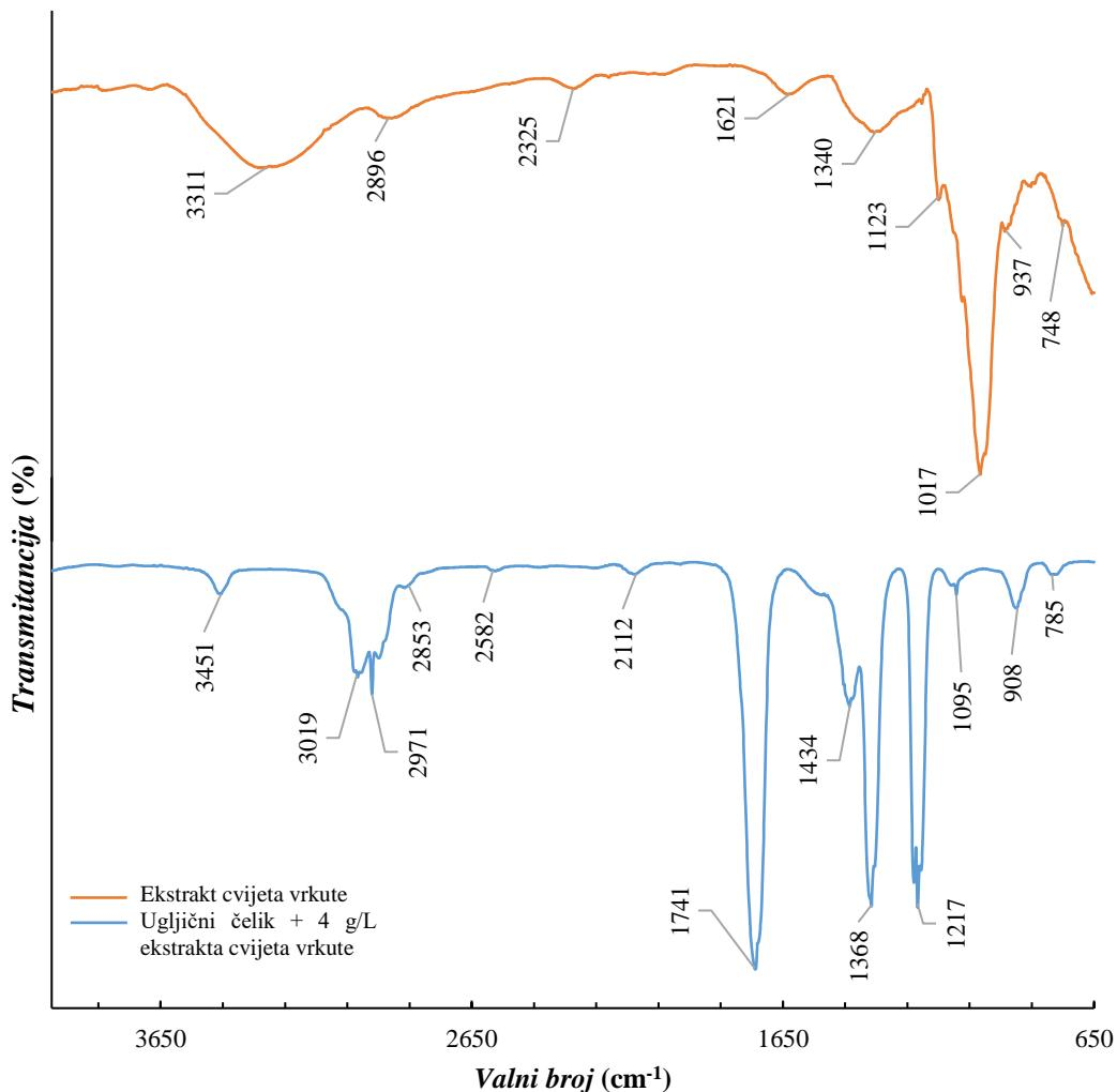
Slika 5-50. FTIR spektri ekstrakta cvijeta vrkute i površine ugljičnog čelika nakon 4 sata izlaganja sintetskoj slojnoj vodi zasićenoj s CO<sub>2</sub> u prisutnosti 4 g/L ekstrakta
