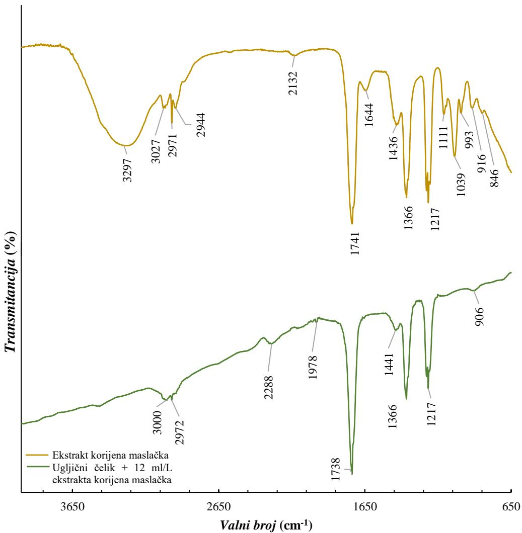
Slika 5-51. FTIR spektri ekstrakta korijena maslačka i površine ugljičnog čelika nakon 4 sata izlaganja sintetskoj slojnoj vodi zasićenoj s  $\text{CO}_2$  u prisutnosti 12 ml/L ekstrakta
