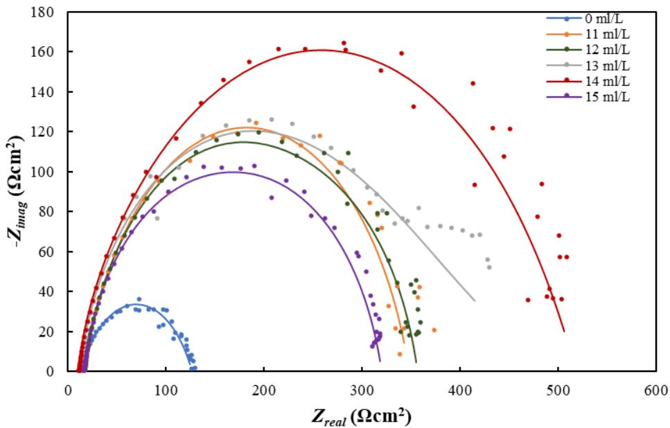
Slika 5-39. Nyquistov prikaz podataka snimljenih na uzorku ugljičnog čelika u simuliranoj slojnoj vodi zasićenoj s  $\text{CO}_2$  u protočnim uvjetima za različite koncentracije ekstrakta korijena maslačka
