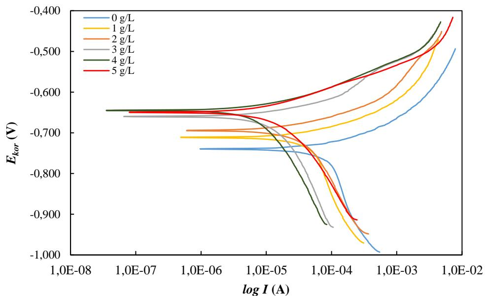
Slika 5-29. Polarizacijske krivulje snimljene na uzorku ugljičnog čelika u simuliranoj slojnoj vodi zasićenoj s  $\text{CO}_2$  bez i u prisutnosti različitih koncentracija ekstrakta cvijeta vrkute
