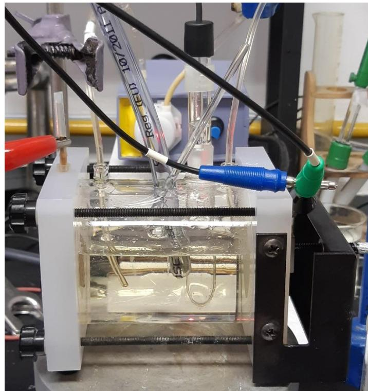
Slika 4-2. Protočna čelija s troelektrodnim sustavom
