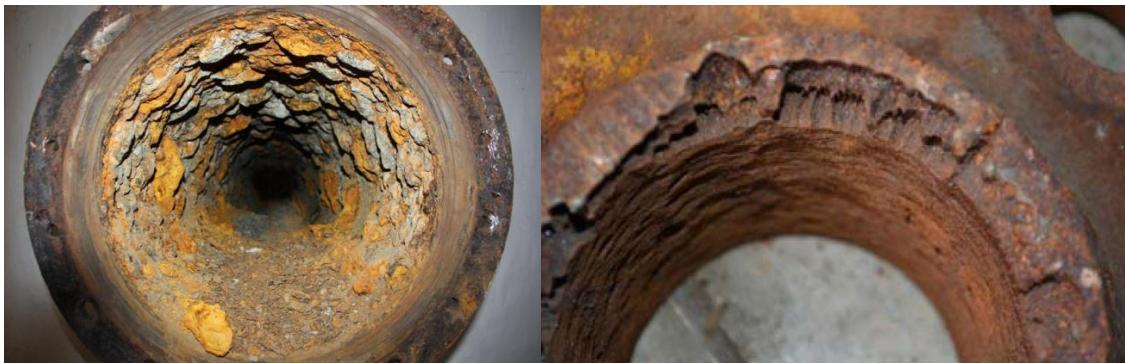
Slika 2-9. Primjeri erozijske korozije (Frazier, 2017.; Bhardwaj, 2020.)
