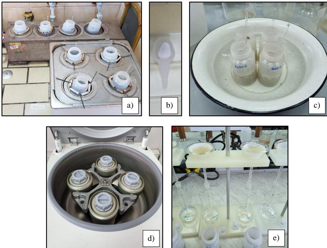
**Slika 3.7.** Slijed postupaka kod DCB metode: a) kivete stavljeni na parnu kupelj; b) 1 g natrijevog ditionita; c) hlađenje sadržaja u kivetama; d) kivete stavljeni u centrifugu; e) filtracija (foto: Lara Antoš).
