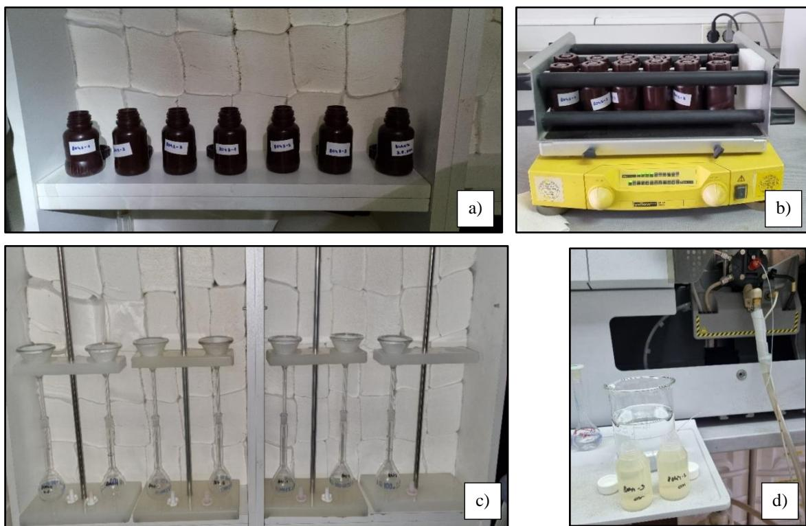
**Slika 3.8.** Slijed postupaka kod oksalat metode: a) tamne poliboćice; b) uzorci u poliboćicama stavljeni na tresilicu; c) aparatura za filtriranje; d) otopine spremne za analizu na AAS-u (foto: Lara Antoš).
