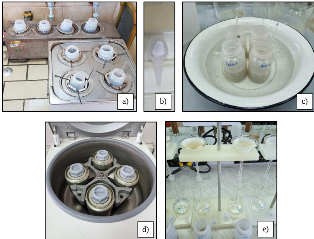
Slika 3.7. Slijed postupaka kod DCB metode: a) kivete stavljene na parnu kupelj; b) 1 g natrijevog ditionita; c) hlađenje sadržaja u kivetama; d) kivete stavljene u centrifugu; e) filtracija (foto: Lara Antoš).
