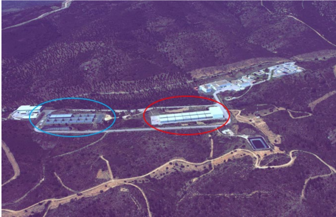
Slika 2.4. 28 betonskih kaset. Sjeverni plato (crveno zaokruženo) sa 16 kaseti i Južni plato (plavo zaokruženo) sa 14 kaseti (TECNATOM, Nuclear sector).
