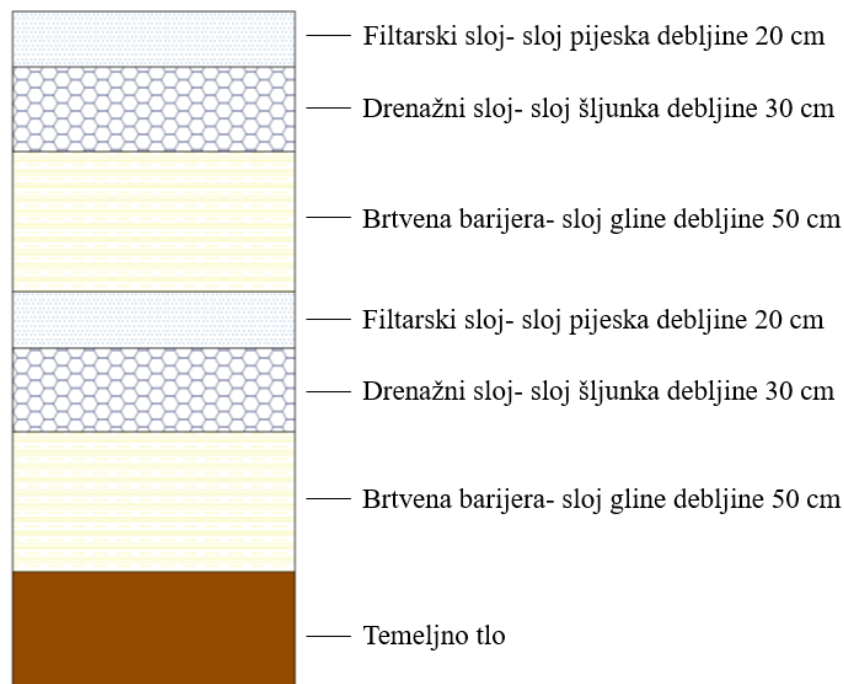
Slika 3.6. Prikaz slojeva temeljnog zaštitnog sustava u presjeku s vrstom materijala i debljinom slojeva.
