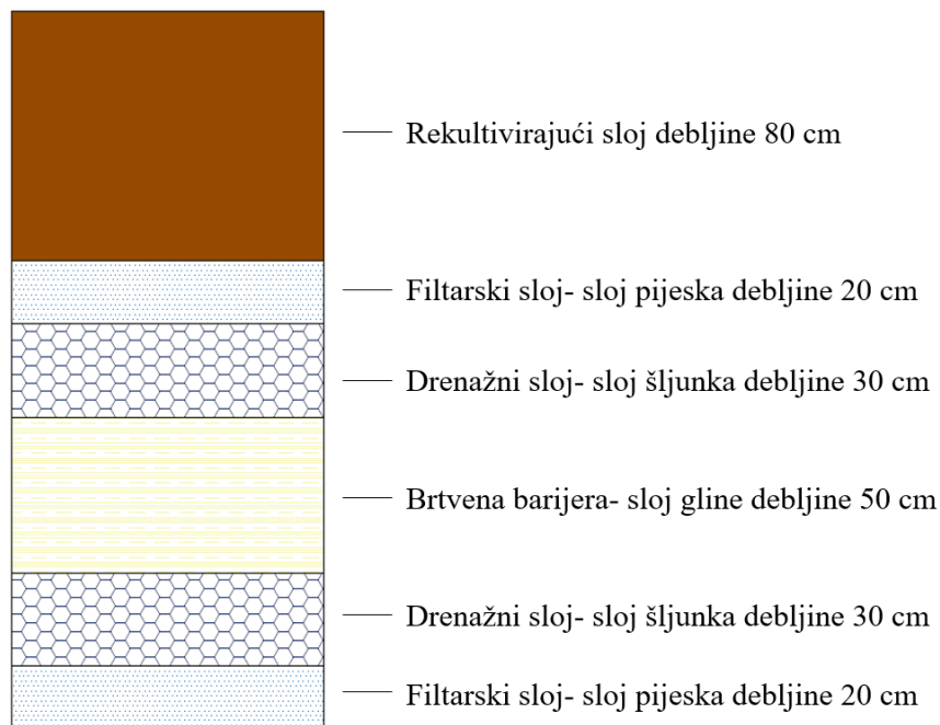
Slika 3.5. Prikaz slojeva pokrovnog zaštitnog sustava u presjeku s vrstom materijala i debljinom slojeva.
