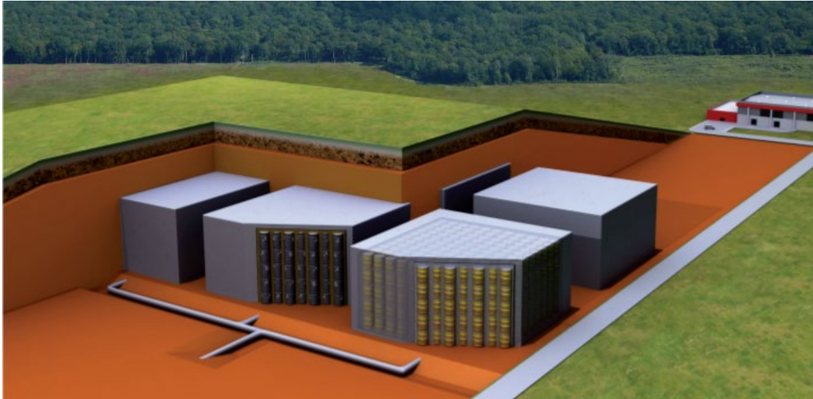
Slika 2.9. Prikaz presjeka odlagališta l'Aube, betonskih kaset napunjenih odpadom i zatvorenim betonskim poklopcem, drenažni sloj za odvodnju oborinskih voda te konačno zatrpane kasete s debelim slojem gline (Andra, Nuclear waste in France).
