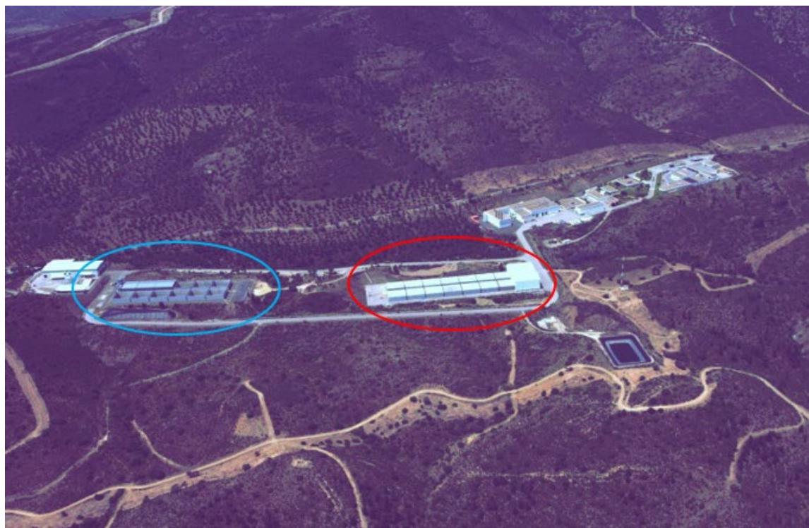
**Slika 2.4.** 28 betonskih kaseta. Sjeverni plato (crveno zaokruženo) sa 16 kasetama i Južni plato (plavo zaokruženo) sa 14 kasetama (TECNATOM, Nuclear sector).
