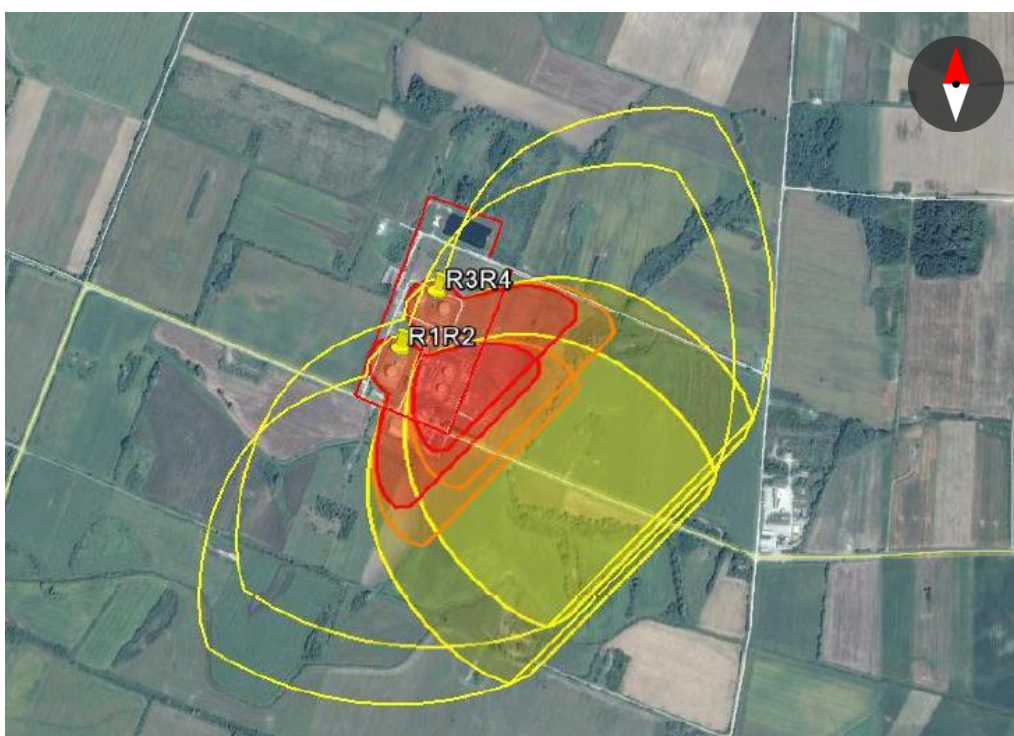
Slika 5-13. Zone ugroženosti uslijed disperzije plinske faze nakon izlivanja nafte iz oba spremnika u tankvanu na OS Beničanci (INA, d.d., 2017c)
