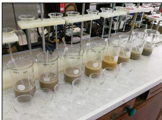
Slika 7- 12 Otapanje gipsa u uzorcima boksita.
