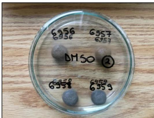
Slika 7- 13 Uzorci boksita tretirani DMSO-om.
