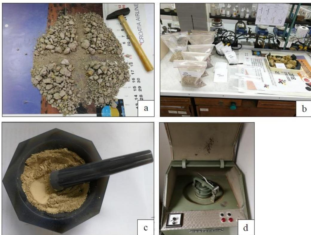
Slika 7-8 Priprema uzorka: a) četvrtanje; b) odvajanje uzorka za drobljenje; c) drobljenje u ahatnom tarioniku; d) drobljenje u Fe mlinu.
