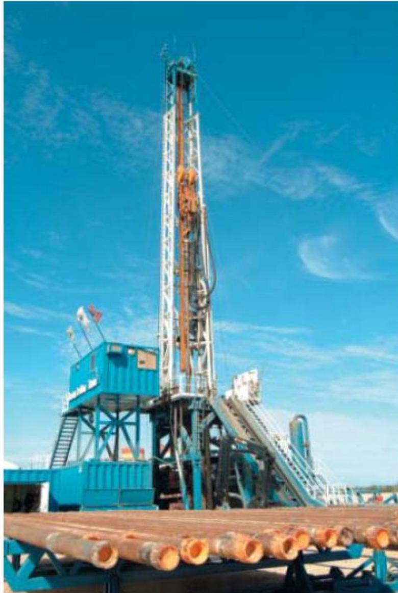
Slika 2-2. Bušaće postrojenje za bušenje uz primjenu kolone zaštitnih cijevi (Fontenot et al., 2005)
