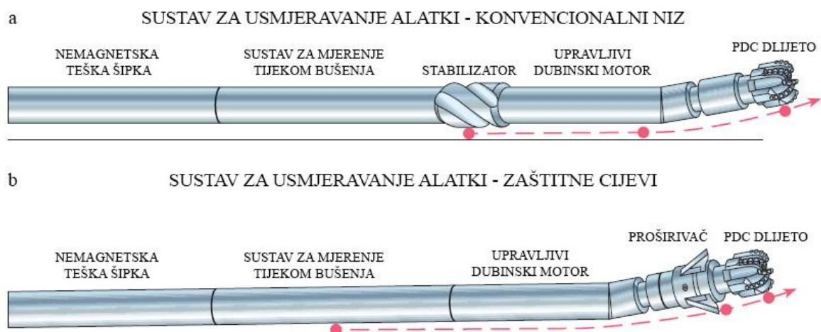
Slika 3-5. Usporedba sustava za usmjeravanje alatki konvencionalnog niza bušaćih alatki i niza zaštitnih cijevi (Fontenot et al., 2005)
