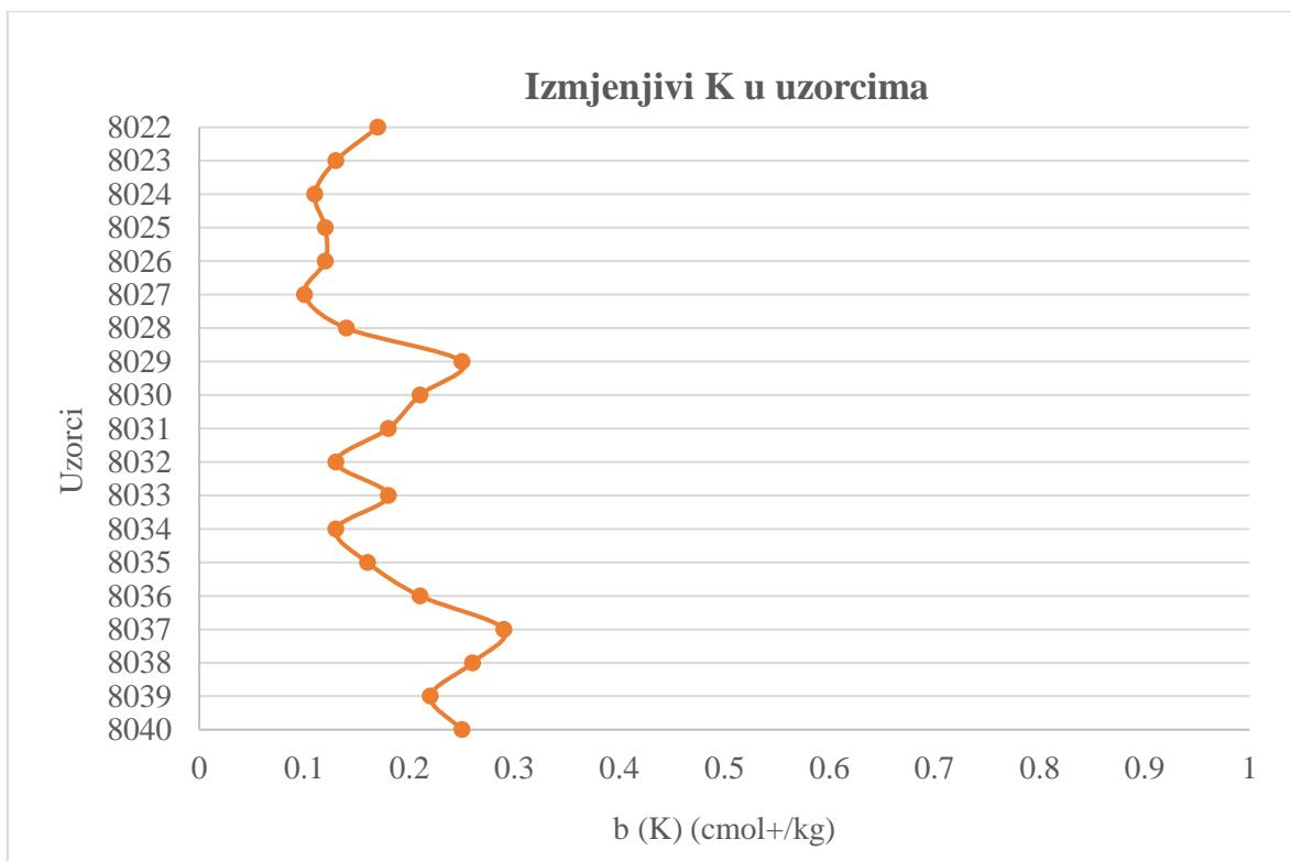
Slika 4.5. Grafički prikaz izmjenjivog K u uzorcima
