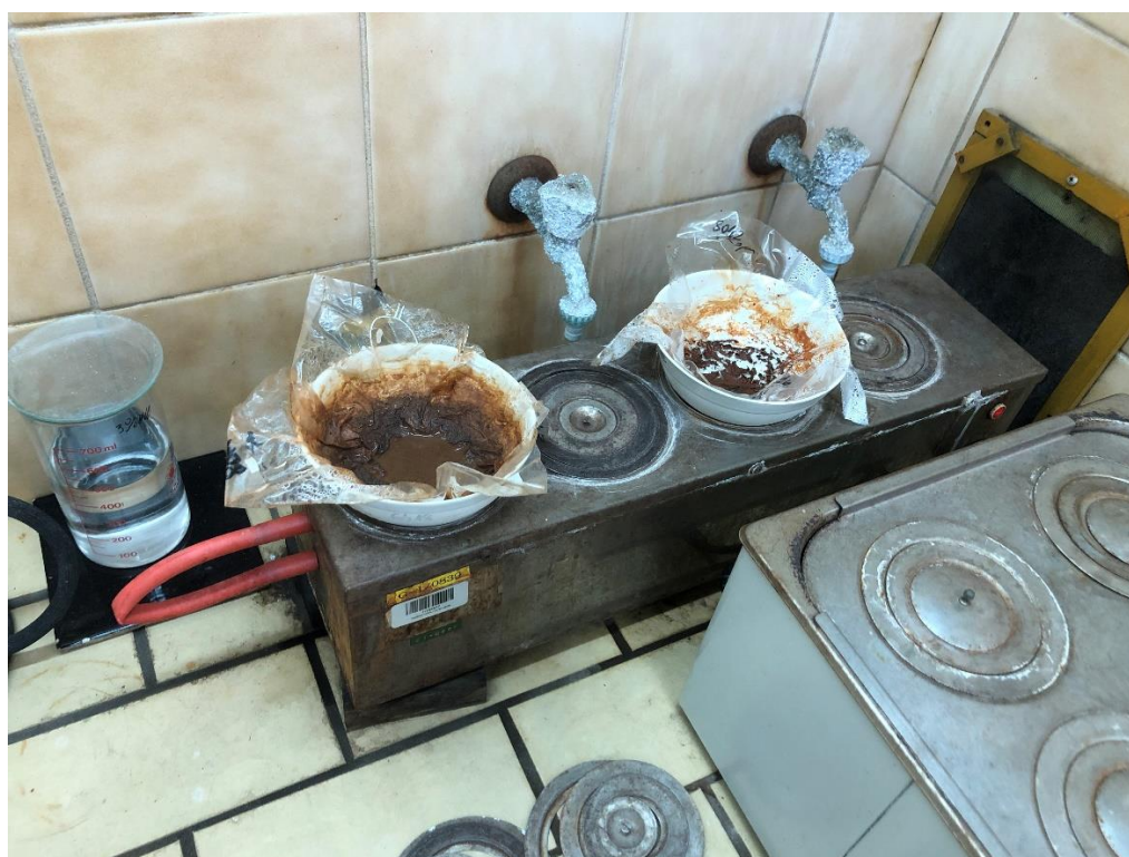
Slika 3.20. Sušenje uzoraka frakcije <2 \mu\text{m} (foto:Fran Vrdoljak)
