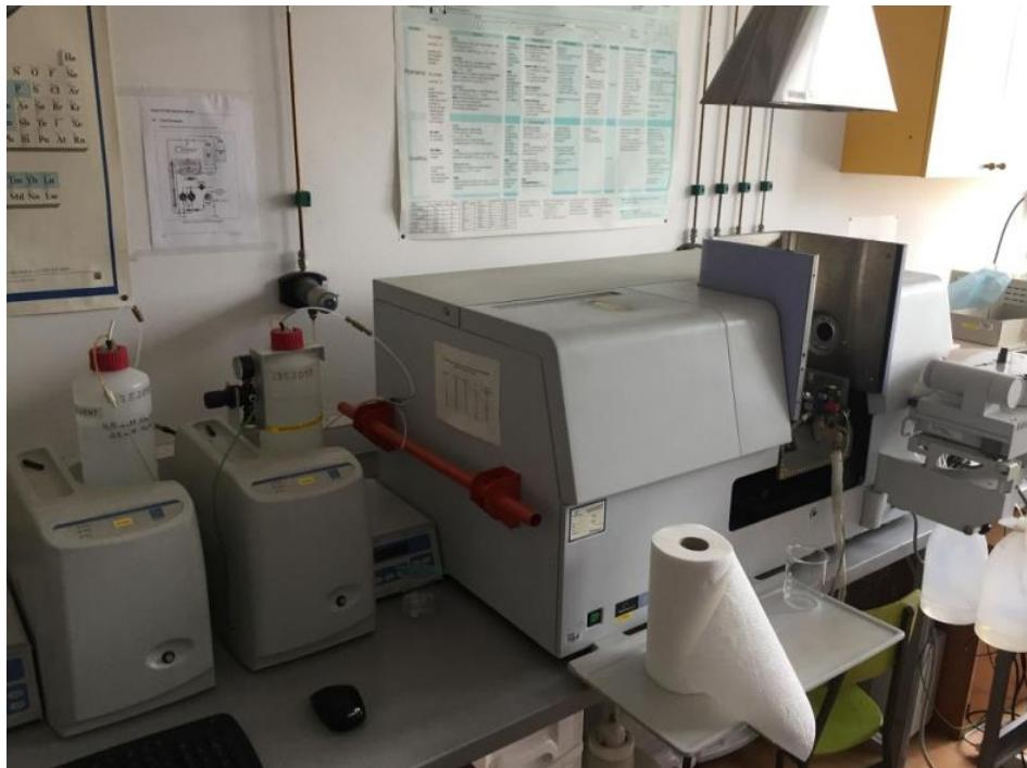
Slika 3.6. Atomski apsorber na RGNF-u (foto: Fran Vrdoljak)
