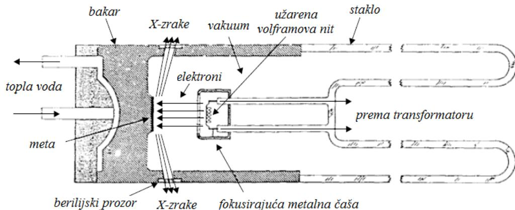
Slika 3.11. Suvremena Coolidgeova cijev (modificirano prema Tomljanović, 2000)
