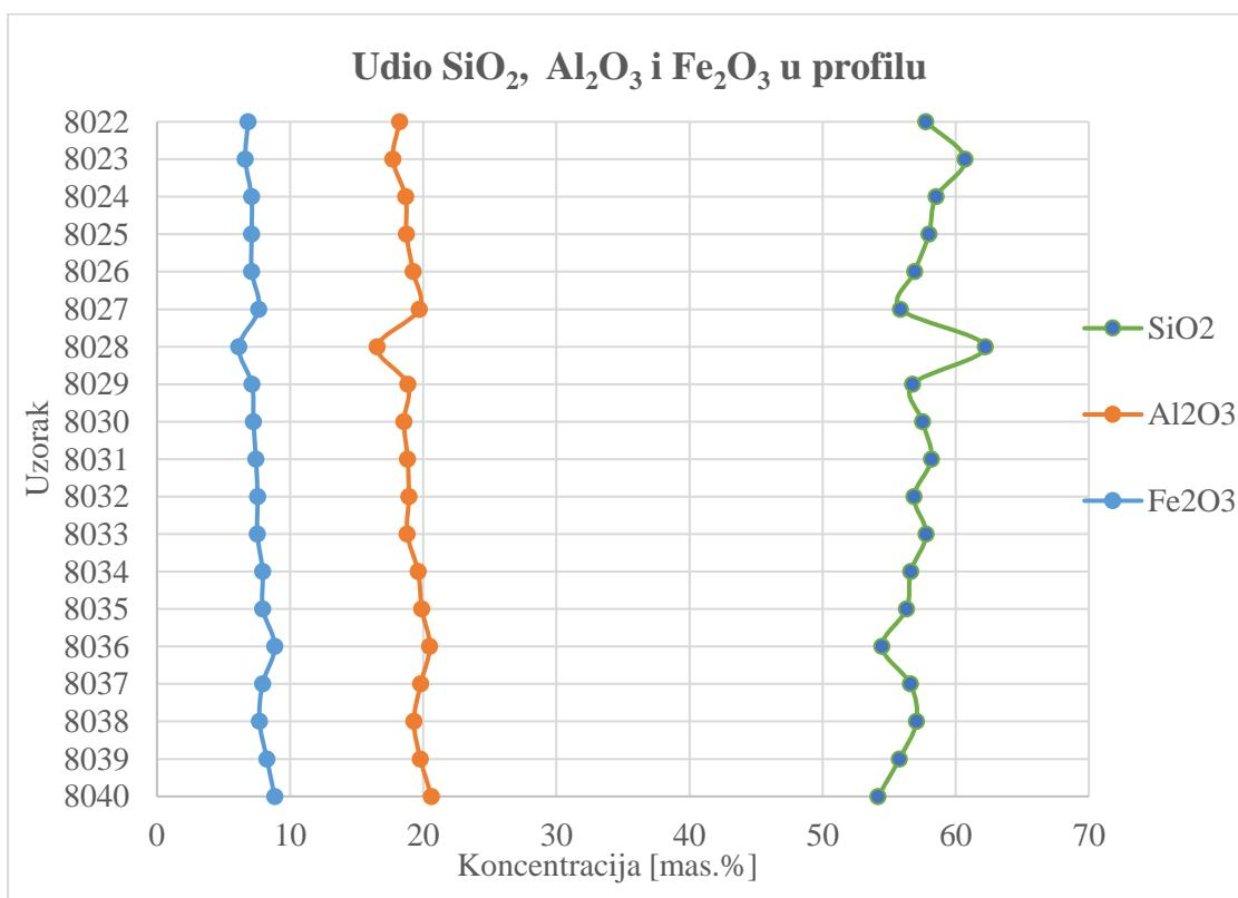
Slika 4.8. Udio  $\text{SiO}_2$ ,  $\text{Al}_2\text{O}_3$  i  $\text{Fe}_2\text{O}_3$  u pedosedimentnom kompleksu Rovinj
