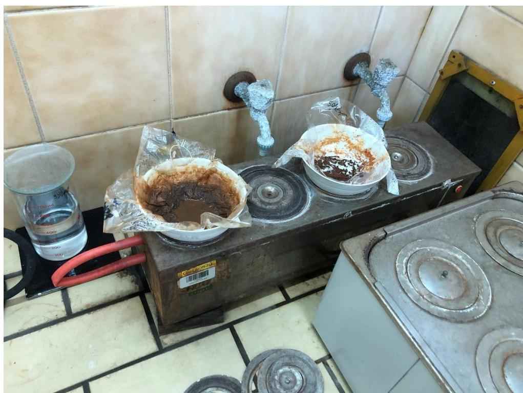
Slika 3.20. Sušenje uzoraka frakcije  $<2 \mu\text{m}$  (foto: Fran Vrdoljak)
