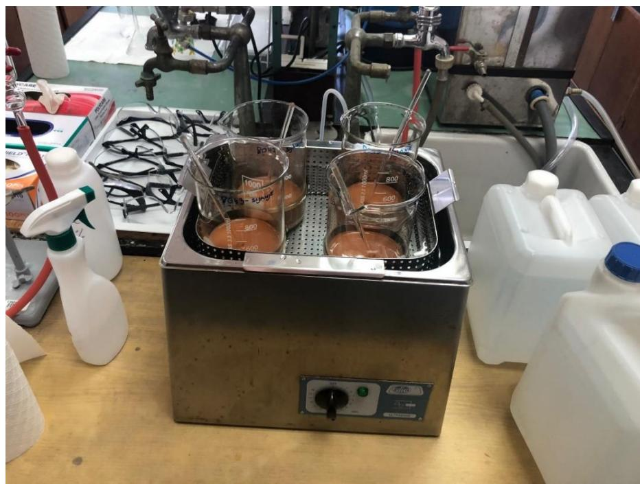
Slika 3.15. Uzorci na ultrazvučnoj kupelji (foto: Fran Vrdoljak)
