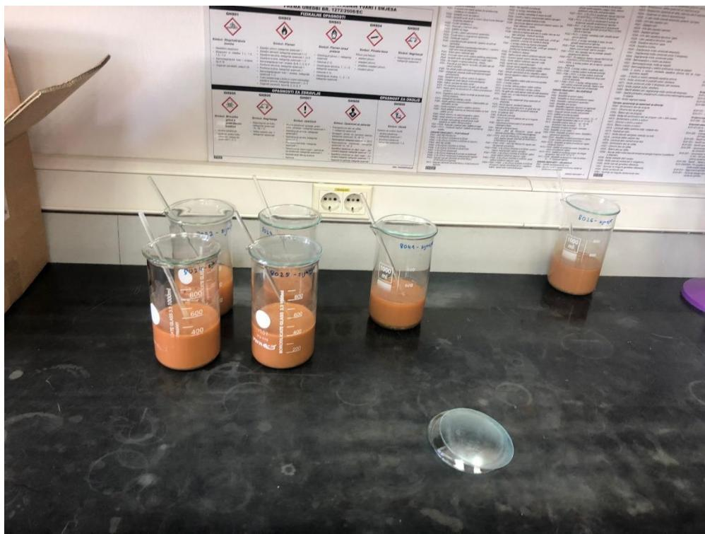
Slika 3.14. Priprema uzorka za mokro sijanje (foto: Fran Vrdoljak)
