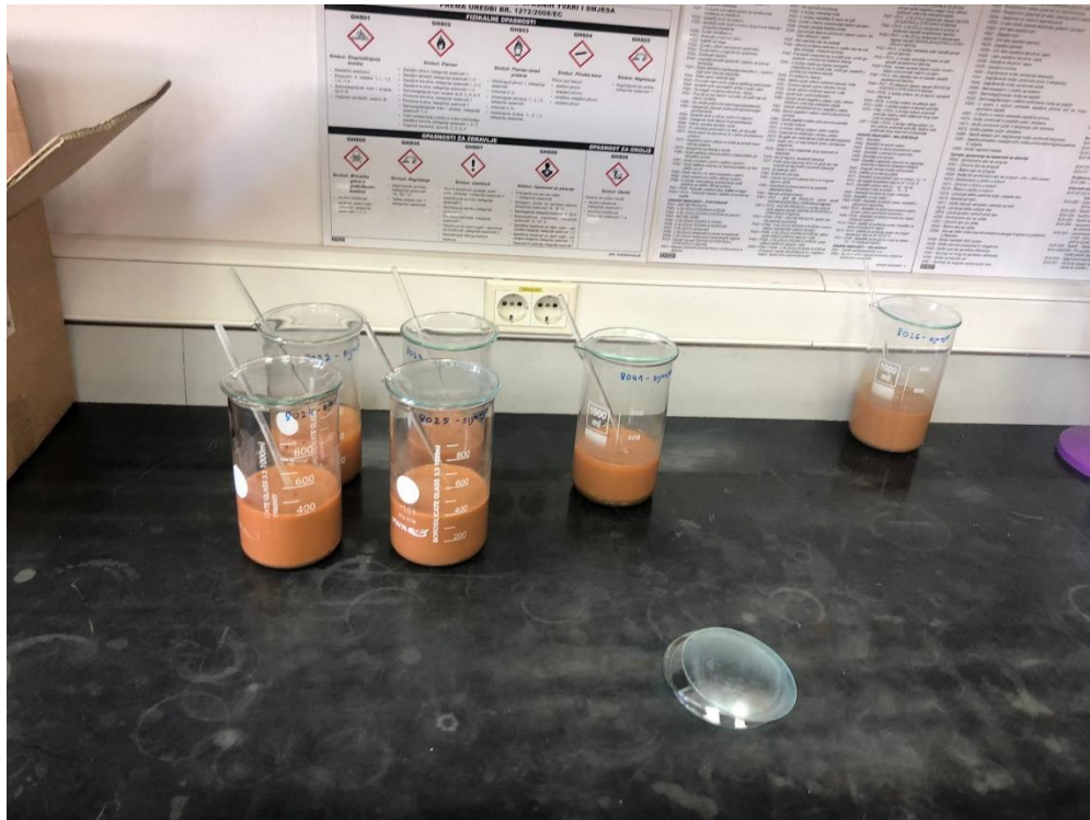
Slika 3.14. Priprema uzoraka za mokro sijanje (foto: Fran Vrdoljak)
