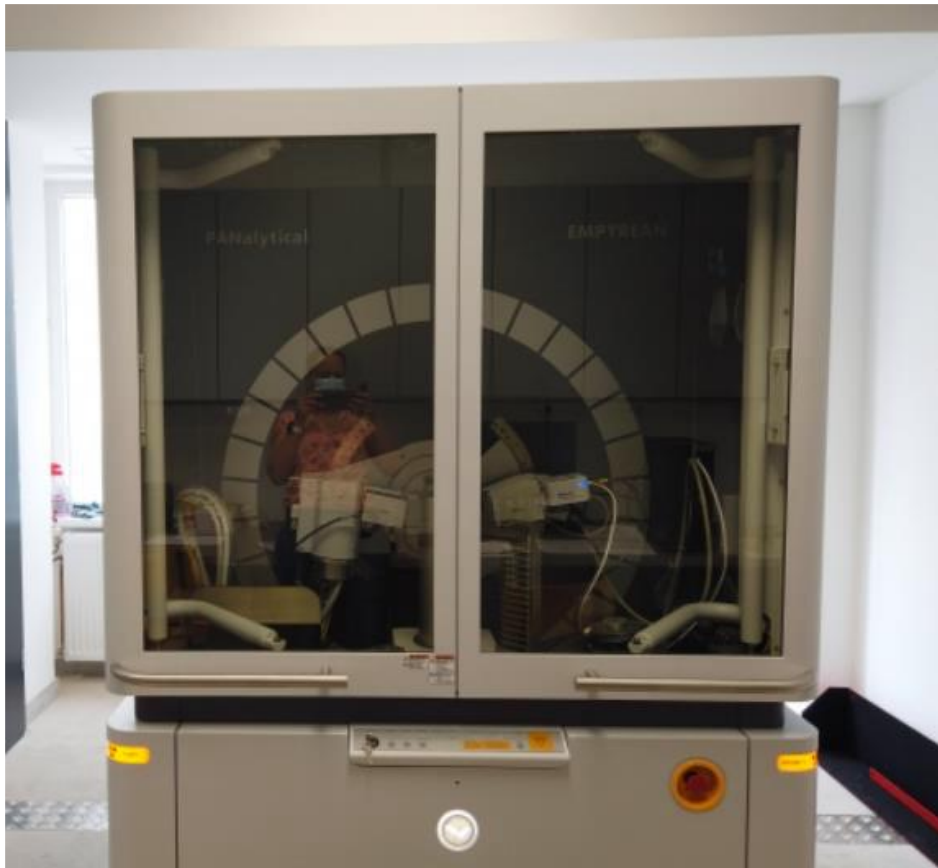
Slika 3.13. Rendgenski difraktometar Malvern Panalytical Empyrean na Rudarsko-geološko-naftnom fakultetu (izvor: Šestar, 2020)
