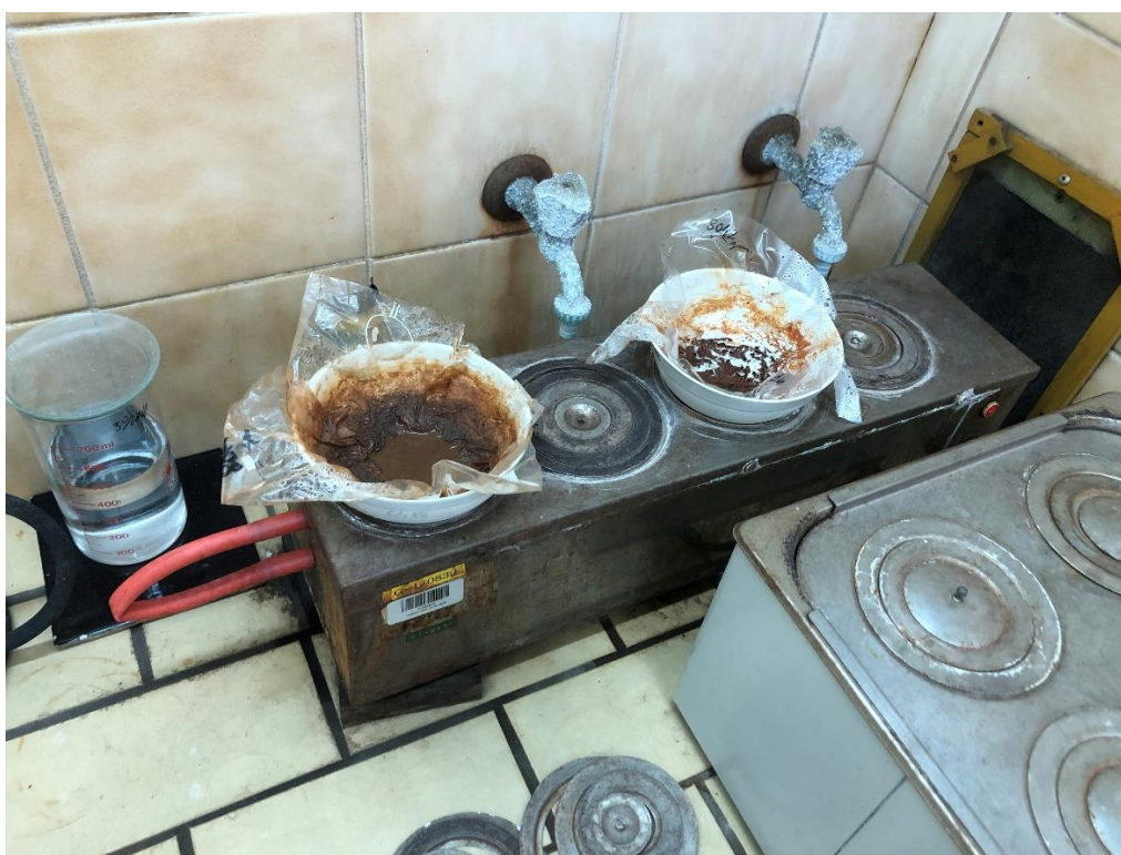
Slika 3.20. Sušenje uzoraka frakcije <2 \mu\text{m} (foto:Fran Vrdoljak)
