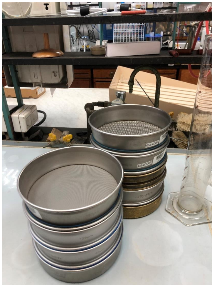
Slika 3.16. Sijanje uzoraka kroz sita promjera 2 mm, 1 mm, 500 \mu\text{m} , 250 \mu\text{m} , 125 \mu\text{m} , 63 \mu\text{m} i 32 \mu\text{m} (foto: Fran Vrdoljak)
