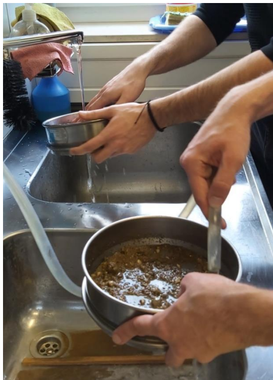
Slika 3-10 Mokro sisanje frakcija manjih od 500 mikrona
