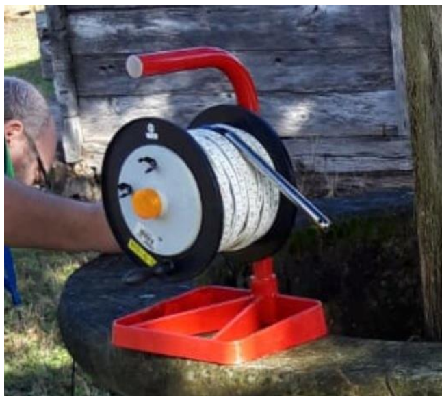
Slika 2-4. Mjerač razine podzemne vode
