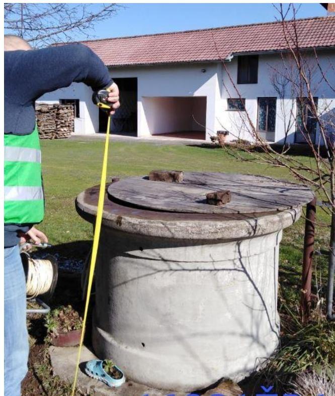
*Slika 2-5. Mjerenje visine zdenca na terenu pomoću metra za mjerenje*
