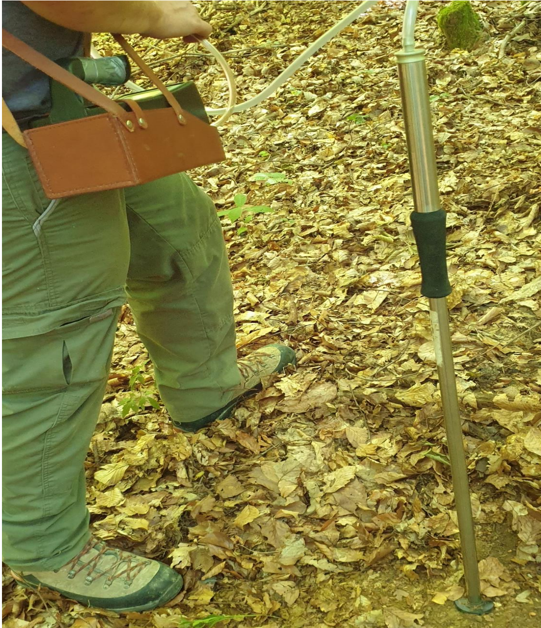
Slika 12. Fotografija mjerenja CO 2 , CH 4 i TP instrumentom ECOPROBE 5
