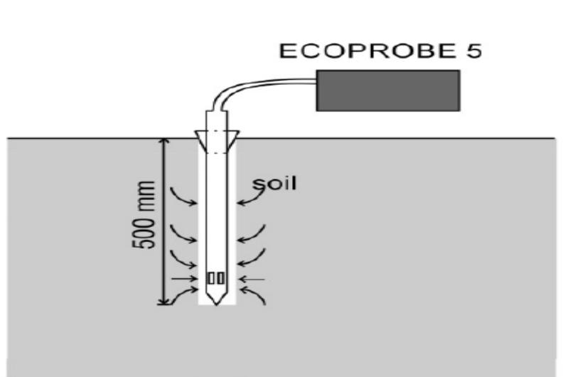
Slika 11. Shema mjerenja CO<sub>2</sub>, CH<sub>4</sub> i TP instrumentom ECOPROBE 5 (Cvetković et al., 2021)
