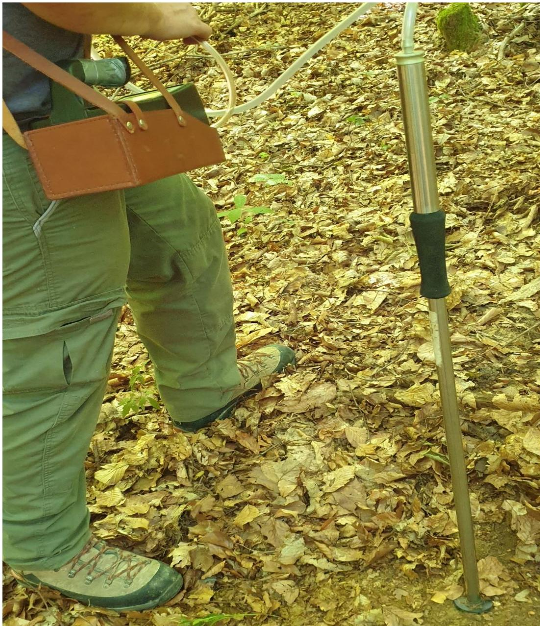
Slika 12. Fotografija mjerjenja CO<sub>2</sub>, CH<sub>4</sub> i TP instrumentom ECOPROBE 5
