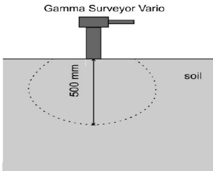
Slika 13. Shema mjerenja Gamma Surveyor Vario-om (**Cvetković et al., 2021**)
