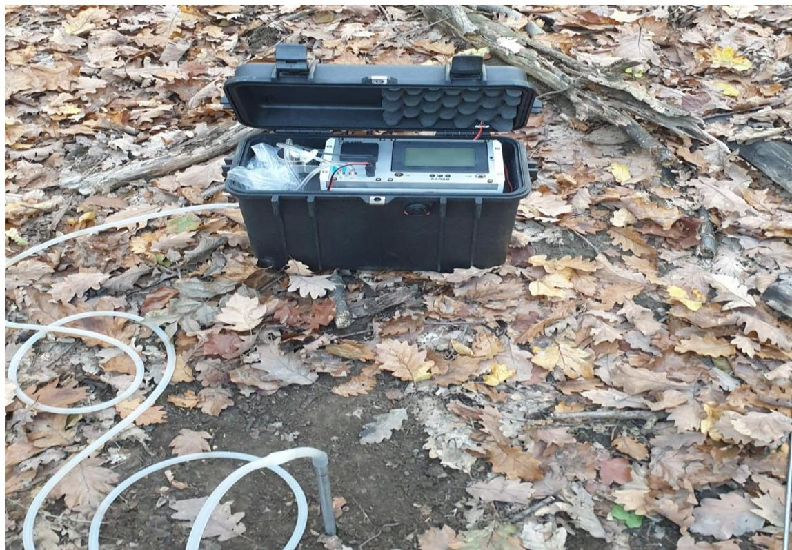
Slika 10. Fotografija mjerjenja koncentracija radona i torona instrumentom SARAD RTM 2200 SG
