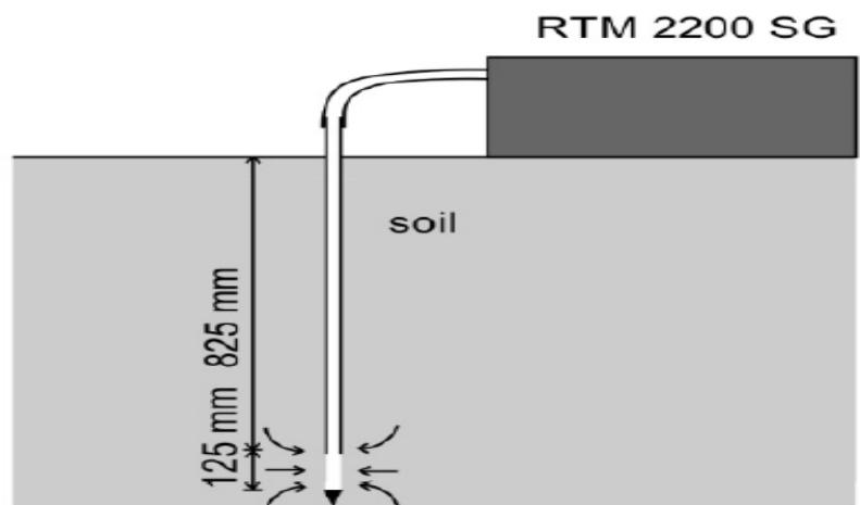
Slika 9. Shema mjerjenja koncentracija radona i torona instrumentom SARAD RTM 2200 SG (Cvetković et al., 2021)
