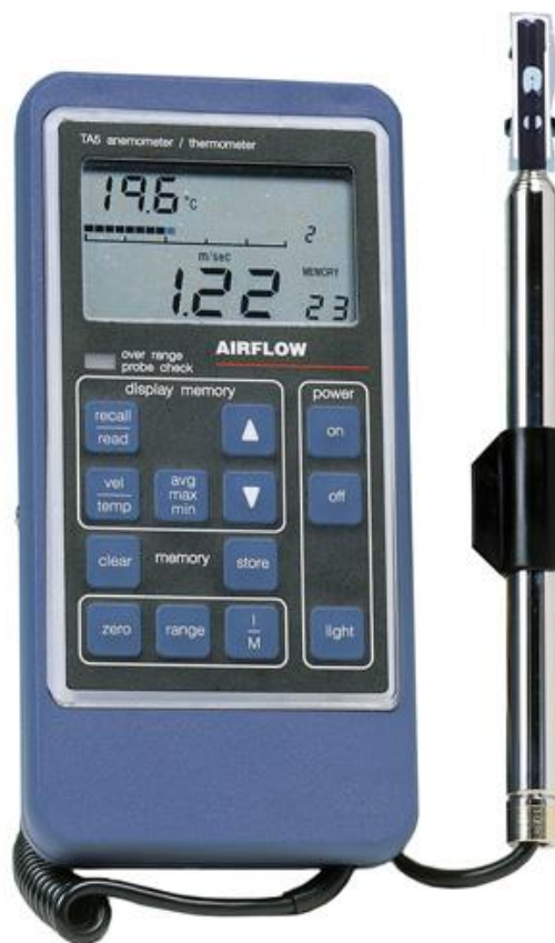
Slika 4-4 Termoanemometar TA5 (TSI, 2020.)
