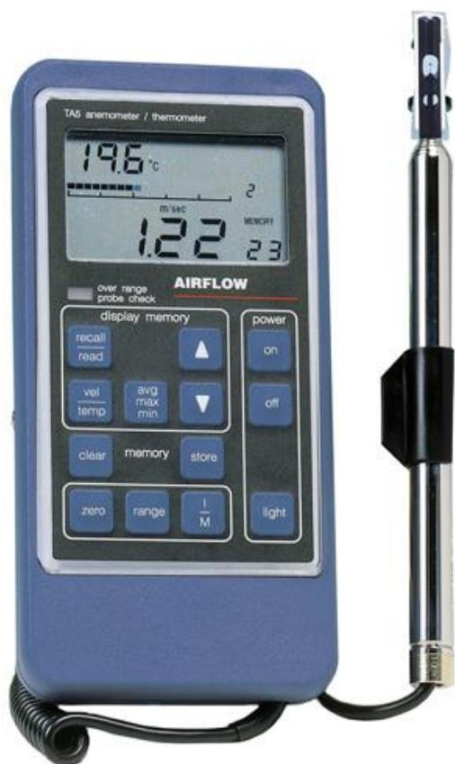
Slika 4-4 Termoanemometar TA5 (TSI, 2020.)
