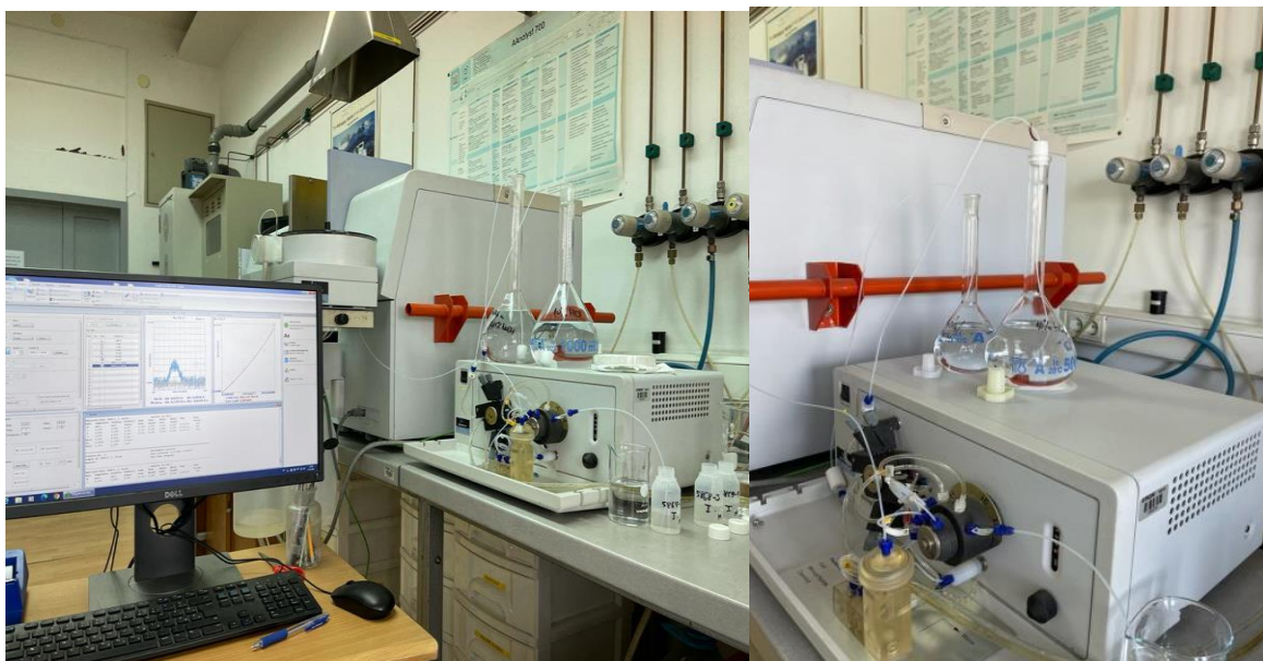
Slika 6–8. Mjerenje As hidridnom tehnikom na AAS Perkins Elmer AAnalyst 700.
