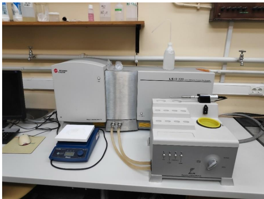
Slika 6–1. Laserski granulometar (Beckman Coulter LS 13 320) na Institutu Ruđer Bošković.
