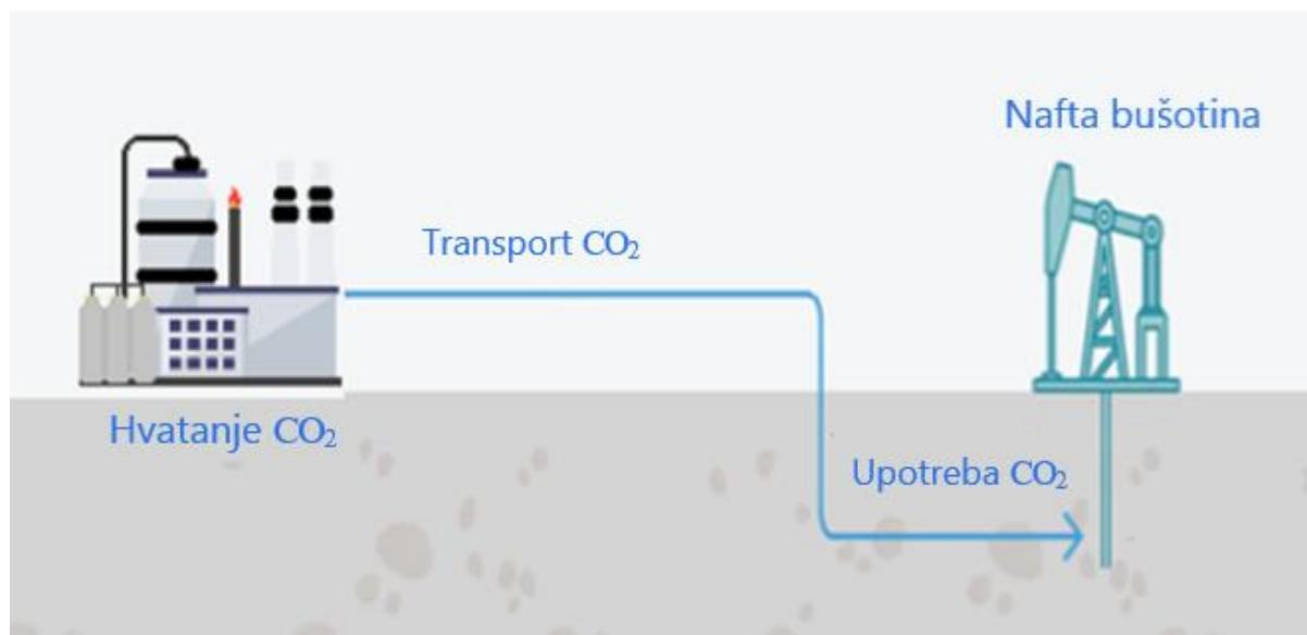
Slika 2-5. Shematski prikaz CO<sub>2</sub>-EOR projekta (prema IEA, 2020)
