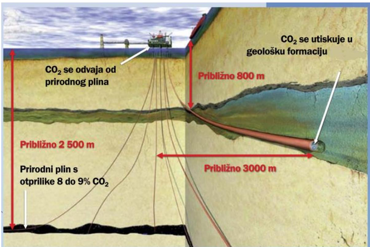
**Slika 4-2.** Vertikalni presjek na lokaciji Sleipner u Norveškoj (CO<sub>2</sub>GeoNet, 2009)
