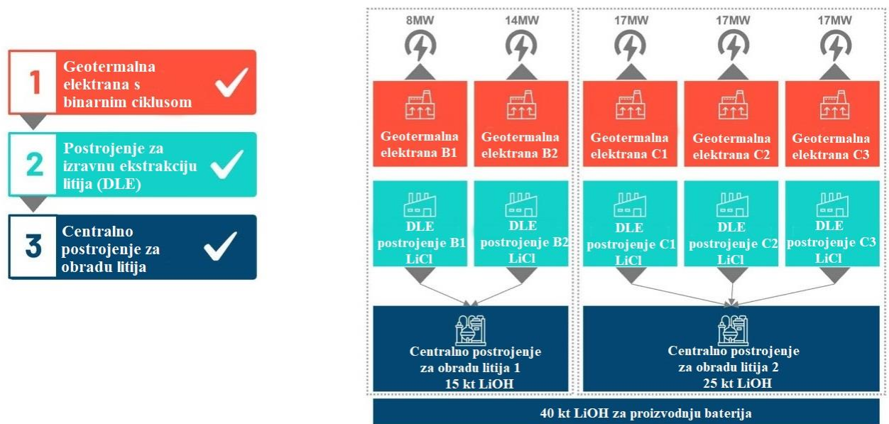
Slika 6-3. Struktura projekta Zero Carbon Lithium (Vulcan Energy, 2021)
